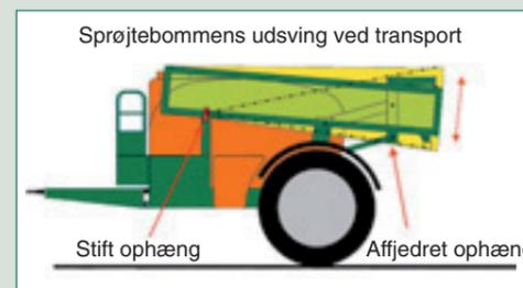
Det hele sidder perfekt: Sprøjtebommen sidder sikkert og uden frigang i transportpositionen. Stød absorberes både ved kørsel på marken og i transportposition gennem parallelogramophænget. Det er ren komfort, og det sikrer frem for alt sprøjtebommen en lang levetid.
