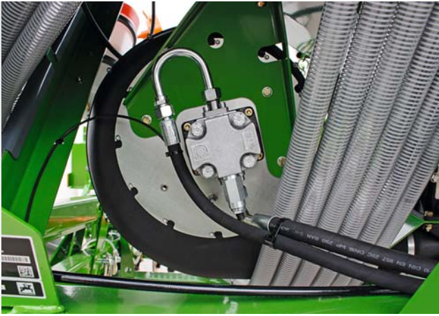
Hydraulic blower fan drive
