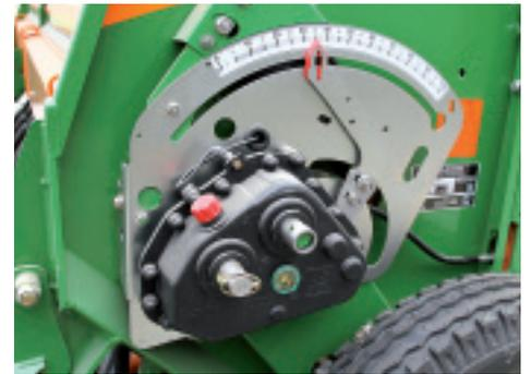
Stufenloses Getriebe mit elektrischer Steuerung.
