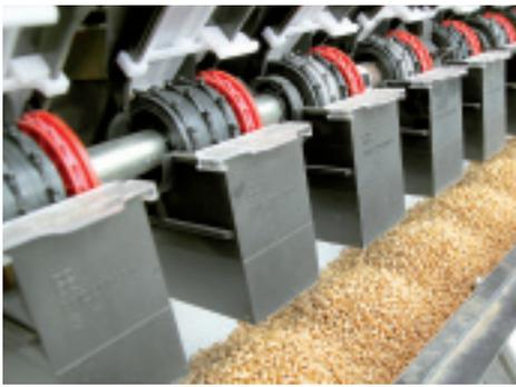
Dosiereinheiten mit Unter- oder Oberaussaat und zweiteiligem Schiebersystem.
