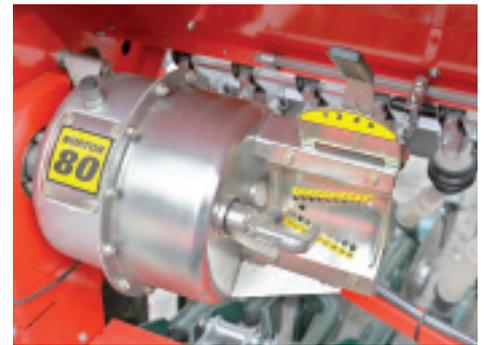
Das ruckfreie Norton-Getriebe ermöglicht eine exakte Längsverteilung.
