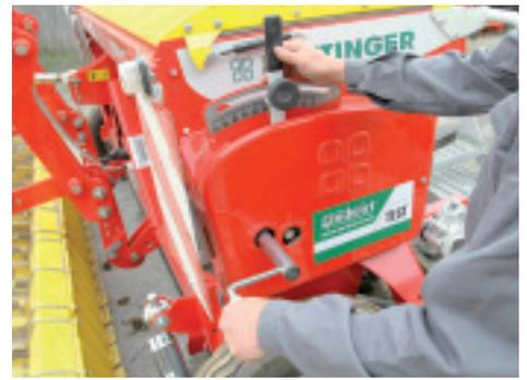
Das stufenlose Getriebe mit Freilauf ermöglicht die Abdrehtprobe bei abgesenkter Maschine.
