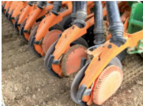
**RoTeC-Control-Schare mit flexibler Tiefenführungs- und Reinigungsrolle.**
