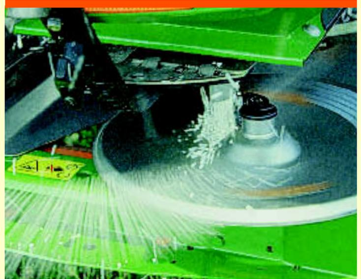
La phase de prélèvement de l'engrais par l'aube d'épandage est décisive pour la précision de la courbe d'épandage.
