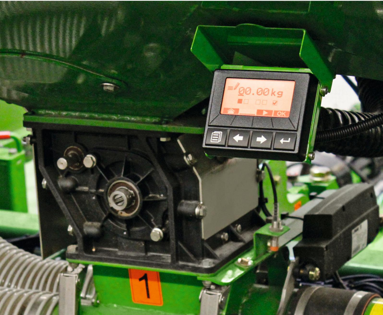
Mit dem TwinTerminal 3.0 kann der Fahrer die Bedienung und Dateneingabe für Kalibriervorgänge direkt an der Maschine vornehmen
