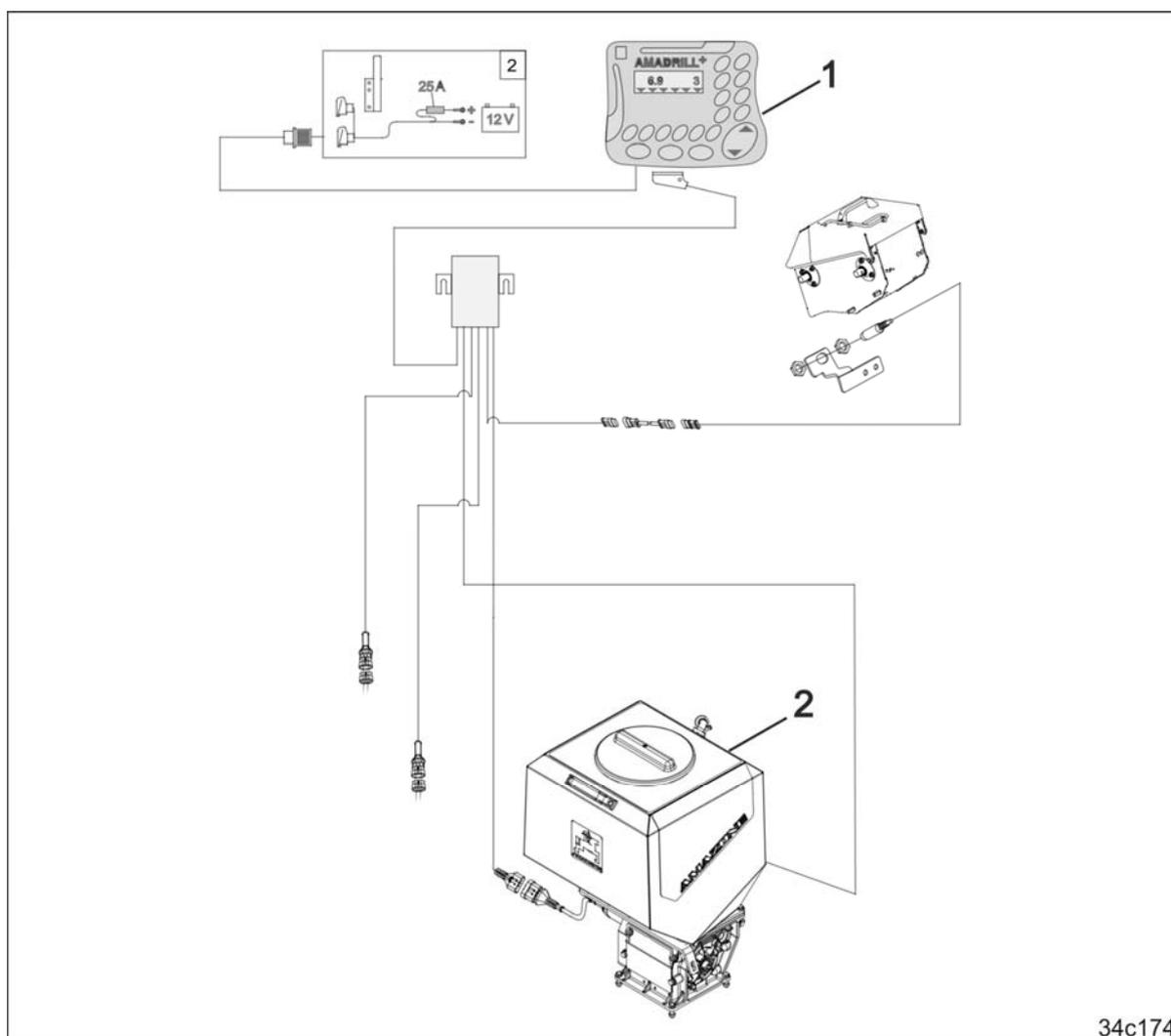
El ordenador de a bordo AMADRILL+ (1) regula y controla el distribuidor de microgranulado (2). Antes de la primera puesta en funcionamiento, deben leerse los datos de identificación de la combinación en la hoja de datos e introducirlos en el ordenador de a bordo.
