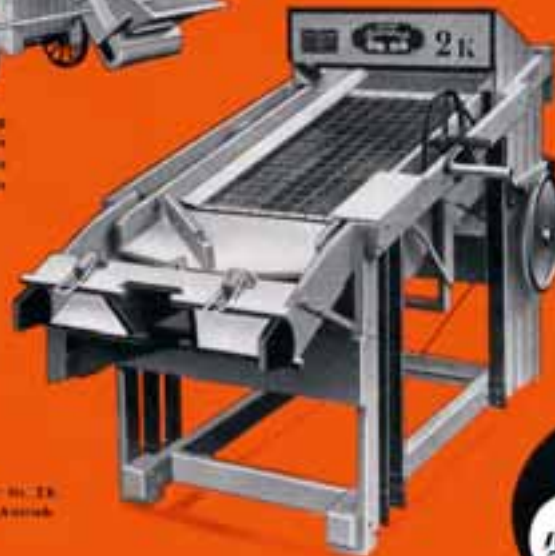
Motorisierter „Federkraft-Sortierer“ mit Zahnring. Auf dieser Maschine werden bis zu 600 kg (130 Zentner) Kartoffeln in drei Stufen nach Größe sortiert, ganz sauber und abgerichtet, und zwar mit sehr wenigen.
