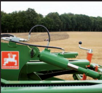
**Arbeitstiefe.** Der Cenius kann optional mit einer hydraulischen Arbeitstiefenverstellung ausgestattet werden.
