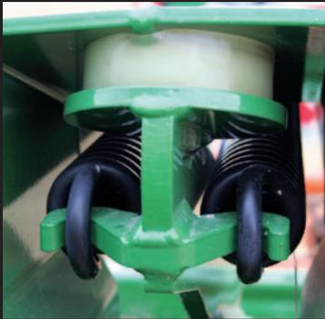
**Sicherheit.** Der Zinken wird durch zwei liegenden Federn und einen Gummipuffer zurückgehalten. Die gesamte Einheit ist mit einer Verkleidung versehen.
