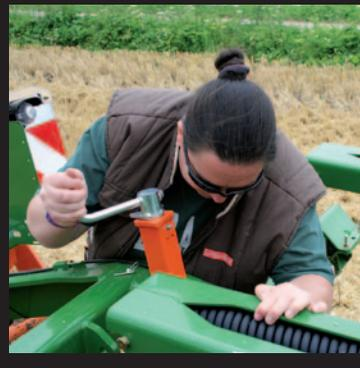
**Schnell.** Die Scharspitze ist mit einem einfachen Hohlspannstift befestigt, was den Scharwechsel erleichtert.
