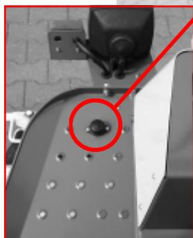
El interruptor de pie permite bloquear las ruedas traseras en línea recta cuando se desee (en marcha atrás sobre rampas de cargamento o para subir una acera por ejemplo).
