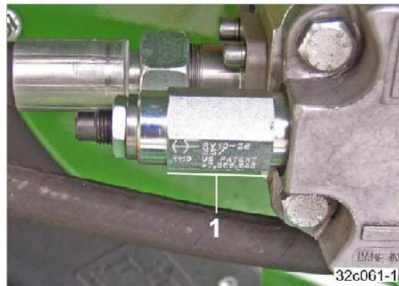
Limiteur de pression avec contour extérieur six pans (1)
