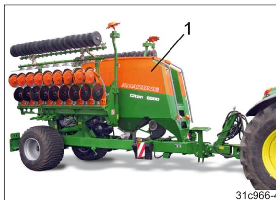
La iluminación interior del depósito está acoplada a la luz de cruce del tractor.
