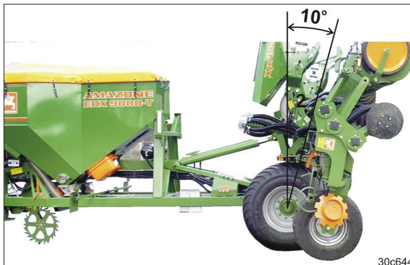
1. Accionar la unidad de mando 2 hasta que ambos discos trazaadores se hayan plegado (posición de estacionamiento).
