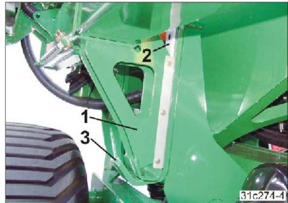
4. Bajar las extensiones de la máquina hasta introducirlas en los soportes de transporte.
