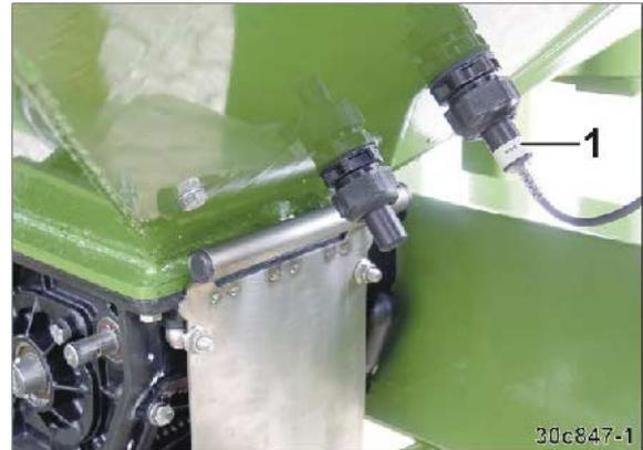
Si el nivel del depósito alcanza el sensor de llenado, suena una señal de alarma y el ordenador de a bordo muestra un mensaje de advertencia (véanse las instrucciones de servicio del ordenador de a bordo).
