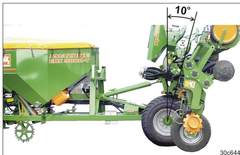
2. Accionar la unidad de mando 1 hasta que al bastidor trasero le queden aprox. 10° para llegar a la posición vertical.
