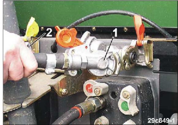
Tras acoplar la máquina se activa el sistema de frenos de servicio de la máquina al accionar el pedal de freno del tractor y el freno de estacionamiento del tractor.
