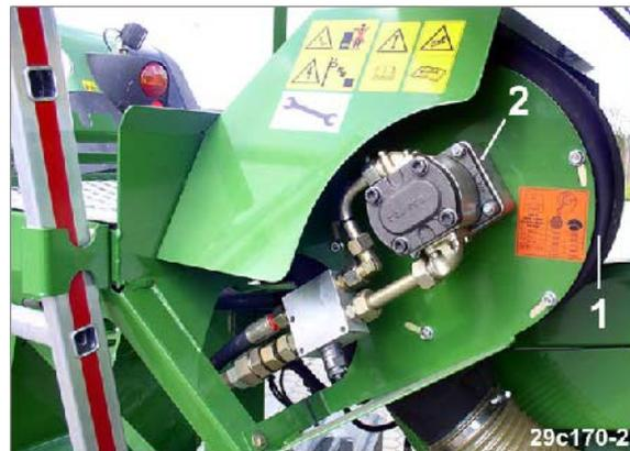
El motor hidráulico puede ser accionado
