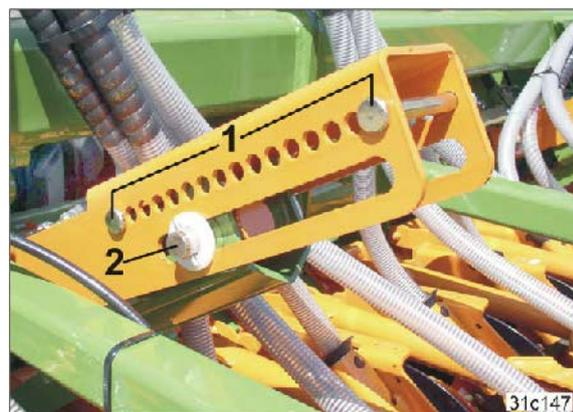
Las máquinas con dos extensiones están equipadas con dos segmentos de ajuste.
