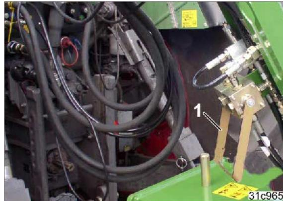
1. Levantar la palanca de la válvula (1).
