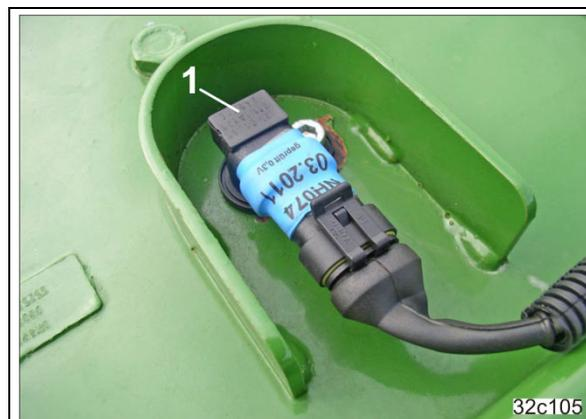
Capteur Hall (1) sur le boîtier de renvoi d'angle
