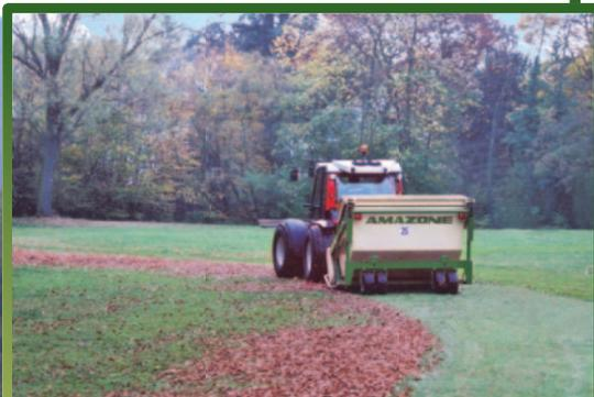
Um im Herbst Golfplätze benutzen zu können, wird der Grasshopper GH mit hervorragendem Saugeffekt auch als Laubsammler eingesetzt. Die rotierenden Messer zerkleinern das Laub. Das Behältervolumen wird durch die vorangehende Zerkleinerung optimal genutzt und die Zersetzung des Herbstlaubes wird somit gefördert.
