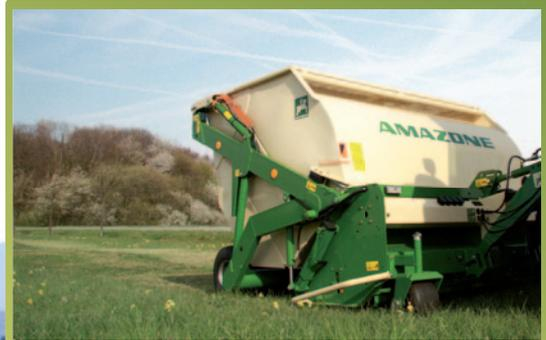
**D**er Grasshopper GH ist Ihre Maschine für effiziente und ökologische Pflegearbeiten auf Golfplätzen. Mit den werkzeuglos austauschbaren Messern werden individuelle Ansprüche des Anwenders erfüllt. Der GH schneidet, vertikutiert, sammelt und das alles in einem Arbeitsgang. Selbst beim Einsatz im hohen oder feuchten Bestand sorgt das Mähwerk für konstanten Mähgutdurchfluss.
