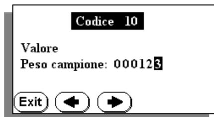
Der Wiegecomputer berechnet, ob das Mustergewicht ausreicht für die Kalibrierung, ist es zu klein kommt eine Fehlermeldung
