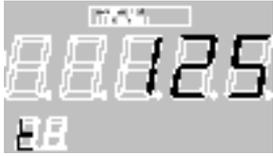
Lassen Sie die Taste
