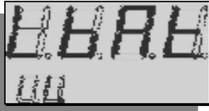
Zu schwacher Spannung: Prüfen Sie die Batterie der Zugmaschine, die Verbindungen und die elektrische Anlage. Um die Spannung zu prüfen, sollen Sie das spezielle Benutzermenü erreichen, wie es in dieser Bedienungsanleitung erzählt wird.
