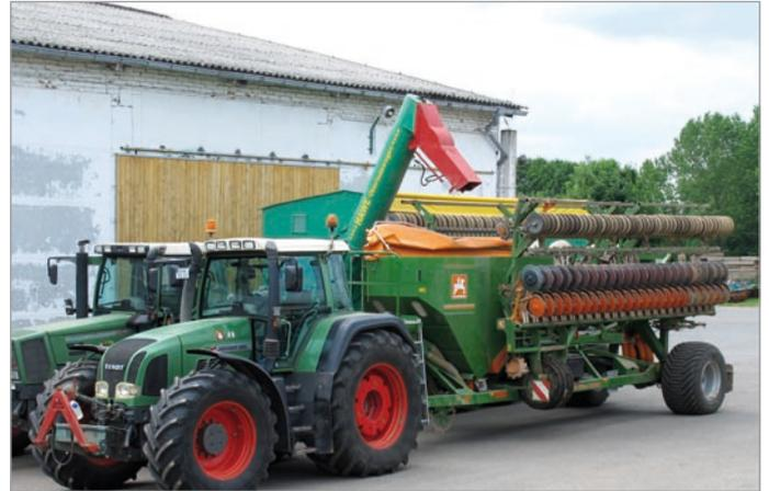
**Demonstration der Überladetechnologie** zur schnellen Befüllung der Cirrus-Bestellkombination. Fahrer Joachim Reinländer kann so nach wenigen Minuten weiter säen.
