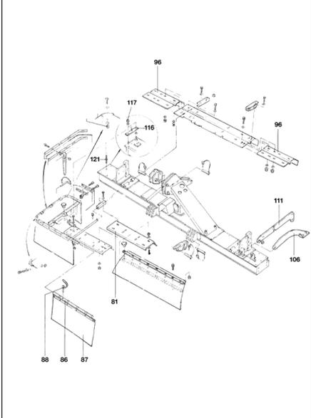
Fig. 4.5 Mähmesser-Ausrüstung KG 451 Seite 10 und KG 452 (1/2)
