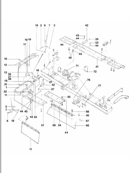
Fig. 4.4 Mähmesser-Ausrüstung KG 401 Seite 8 und KG 402 (2/2)
