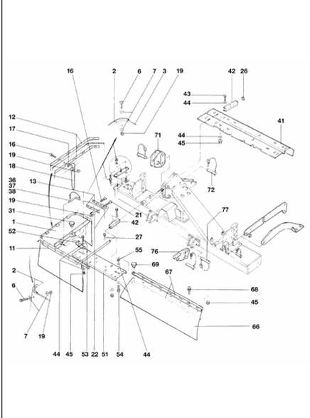
Fig. 4.2 Mähmesser-Ausrüstung KG 301 Seite 4 und KG 302 (2/2)
