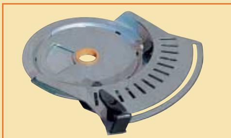
Le dispositif de réglage du débit de l'épandeur E+S en acier inoxydable est doté d'une commande d'ouverture et de fermeture de la trappe, manuelle ou hydraulique pour plus de confort. La largeur d'épandage se règle manuellement ou électriquement en continu.
