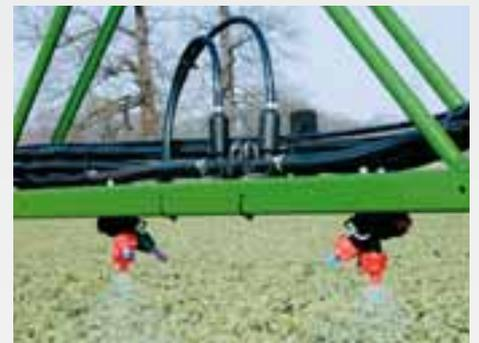
El sistema de circulación forzada (DUS) para todos los pulverizadores AMAZONE mantiene constante la concentración de producto hasta la boquilla. Para limpiar, enjuagar con agua clara hasta la boquilla.
