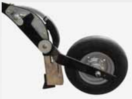
Para maximizar los tiempos de vida útil, las puntas de la reja están provistas de un revestimiento de metal duro. El cómodo sistema de ajuste de profundidad permite cambiar la profundidad de siembra en un tiempo mínimo.
