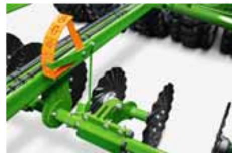
Con la plataforma de discos ondulados Minimum TillDisc, la Cirrus tiene a su disposición otro equipamiento opcional más en el ámbito de las herramientas de preparación. En la distancia entre hileras de 16,6 cm, los discos de corte permiten triturar directamente delante de las rejas de siembra tanto el suelo como restos de la cosecha o también vegetación con vida.
