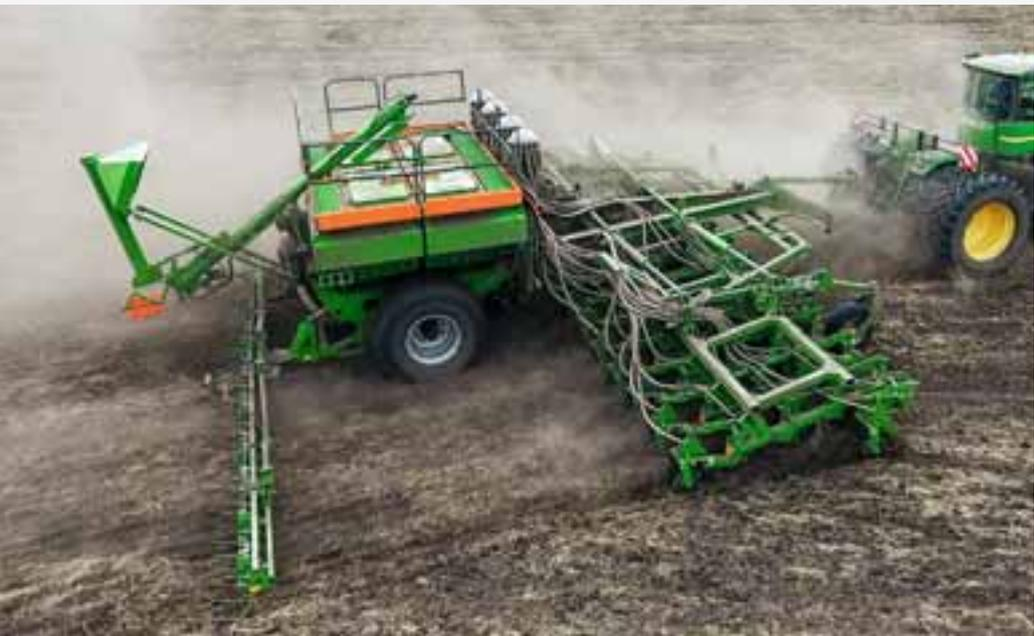
Primera DMC 12001-2C con un ancho de trabajo de 12 m con cabezales distribuidores externos
