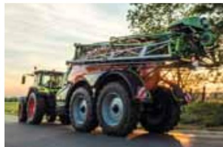
El tren de rodaje hidroneumático y la lanza de enganche con suspensión proporcionan un perfecto confort de marcha. Los grupos de ejes BPW con regulación del nivel de serie se adaptan constantemente al estado de la carga.
