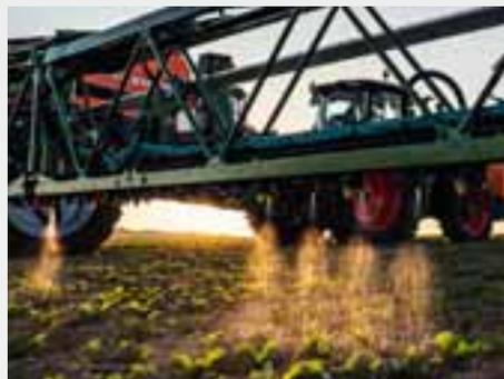
El sistema detecta qué ajustes específicos del campo y con qué mezcla de herbicida recomendada es conveniente utilizar el sistema SmartSpraying.
