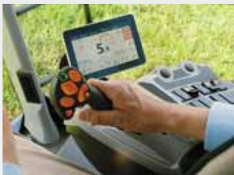
El terminal del vehículo AmaDrive 7.0 está integrado en el reposabrazos ergonómico. En la pantalla táctil a color de 7 pulgadas pueden visualizarse con claridad y manejarse de un modo intuitivo todas las funciones específicas de la máquina.
