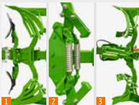
Como protección contra sobrecargas, se puede elegir entre tres sistemas de protección contra piedras diferentes. Uno mecánico mediante tornillos de corte (1), uno semiautomático mediante muelles espirales (2) o una variante hidráulica completamente automática (3).
