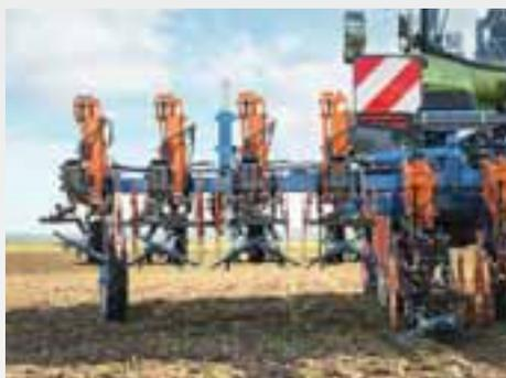
La elevación individual del paralelogramo hidráulico controlado mediante Section Control permite el binado hasta la última punta. En el paralelogramo de binado KPP-L SC es posible una distancia al suelo de los elementos de binado de hasta 50 cm, lo que es perfecto para el uso en cultivos altos.
