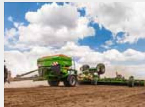
El XTender-T remolcado resulta especialmente apropiado para tractores sin mecanismo de elevación o con poca fuerza de elevación. El tren de rodaje permite una carga de apoyo de 4000 kg.
