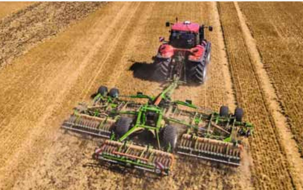
Catros<sup>+</sup> 8003-2TX con rodillos de anillo cónico con perfil de neumático Matrix en un ancho de trabajo de 8 m
