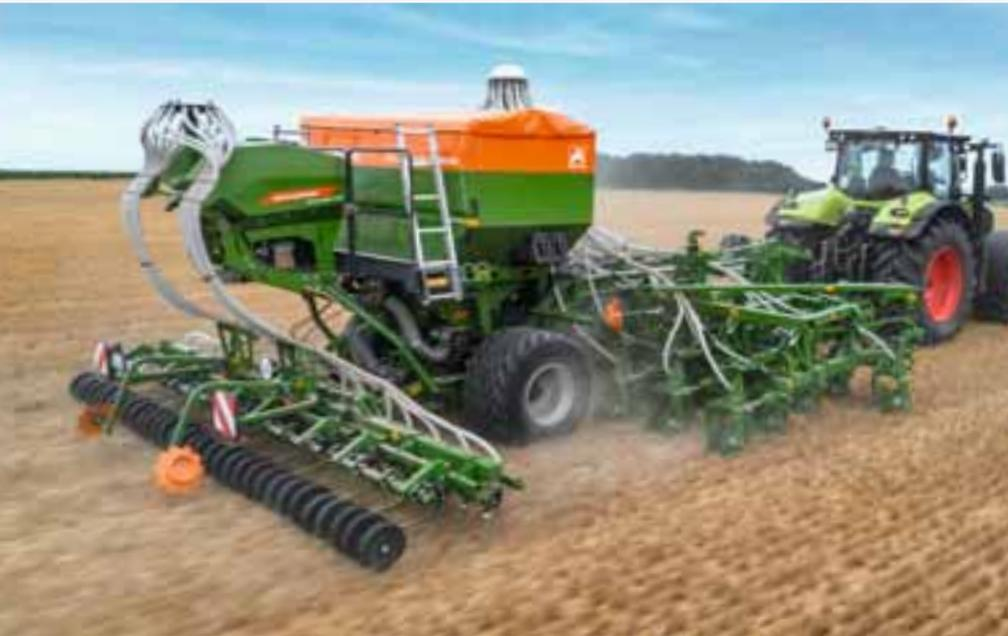
Primera DMC 6000-2C con ancho de trabajo de 6 m y GreenDrill 501
