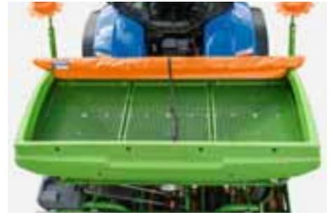
Las generosas medidas de la abertura del depósito, de 2,43 m x 0,91 m, permiten llenar la Centaya sin problemas con una bolsa grande o con una pala de carga frontal. En caso de llenado con sacos, las rejillas de tamiz del depósito de semillas se pueden usar para depositar los sacos.
