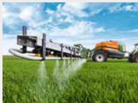
Gracias a su estructura perfilada especial, la barra AMAZONE es ultraligero y, a la vez, sumamente estable. Los anchos de trabajo de la barra de 21 m a 48 m permiten una adaptación óptima a la estructura de la explotación.
