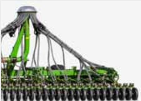
Para utilizar la Citan en terrenos secos, está disponible una rastra de rodillos HD con púas de rastra endurecidas. Los rodillos de compresión posteriores pueden someterse a una presión de hasta 35 kg, con independencia de la reja de siembra, procurando así un buen cierre del suelo.
