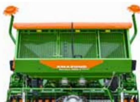
Centaya 4000-C Special con un depósito de doble cámara de 70:30. Así es posible dosificar por separado dos productos diferentes.
