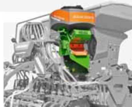
Paralelamente a la siembra también se pueden esparcir con la Centaya semillas de hierba, producto antibabosas o cultivos intermedios. Para ello se dispone como equipamiento especial de la sembradora de cultivos intermedios GreenDrill 200-E, que tiene 200 l de capacidad del depósito, eje dosificador de accionamiento eléctrico y turbina y se monta en la parte trasera de la máquina.
