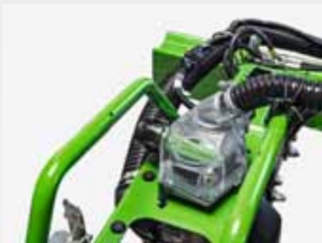
Con el nuevo sistema de alimentación de semillas Central Seed Supply, las semillas se conducen por corriente de aire desde el depósito central hasta los grupos de separación. Allí, las semillas se almacenan de forma intermedia por hilera en un pequeño depósito de reserva.
