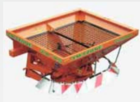
La abonadora acoplada ZA-XS H se ha diseñado especialmente para la construcción de carreteras. Gracias a su accionamiento hidráulico, esta abonadora de dos discos es idónea para apisonadoras que cubren la calzada con gravilla.
