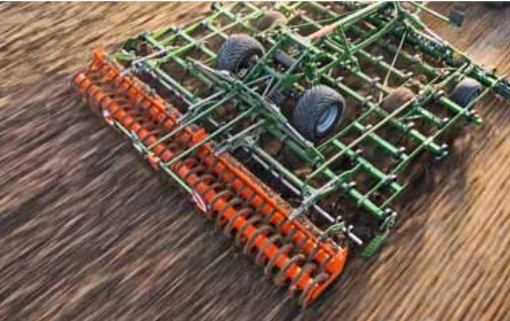
Cobra 7002-2TX durante la roturación de terreno con rastrojos
