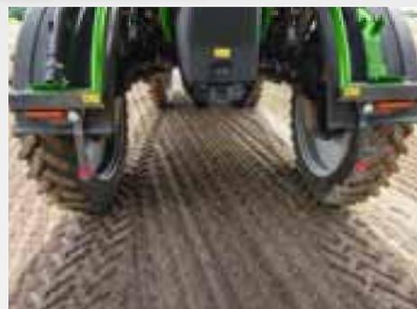
Cabe destacar la función de protección del suelo de la conducción sobre una traza desplazada con la que, por ejemplo, las ruedas delanteras puede ajustarse al ancho de vía mínimo y las ruedas traseras al ancho de vía máximo.
