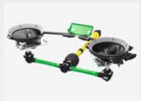
En la versión Tronic, el mecanismo esparcidor se acciona a través de la toma de fuerza. El esparcidor está protegido de serie contra sobrecargas mediante un árbol de transmisión con embrague de fricción.
