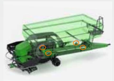
En el sistema de pesaje integrado en el bastidor Profis, el depósito y su bastidor están conectados por medio de cuatro células de medición para el pesaje con un bastidor portante separado.
