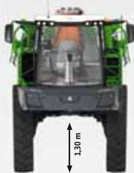
Ajuste del ancho de vía de 2,00 m-2,75 m
