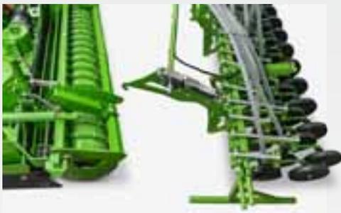
Con un ancho de trabajo de 6 m, toda la unidad de siembra puede desmontarse en tan solo 30 min. La Avant con ancho de trabajo de 3 m o 4 m puede equiparse para el uso individual en aprox. 5 minutos gracias a QuickLink.
