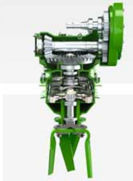
El elemento central de la nueva KE 02 es el tren de engranajes DirectDrive, a través del cual se transmite el mayor flujo de fuerza directamente a los engranajes rectos de las púas de la grada rotativa. Al igual que en los cultivadores rotativos KX y KG, aquí tampoco se produce un desvío. Esto garantiza una excelente transmisión de la fuerza con un desgaste reducido.
