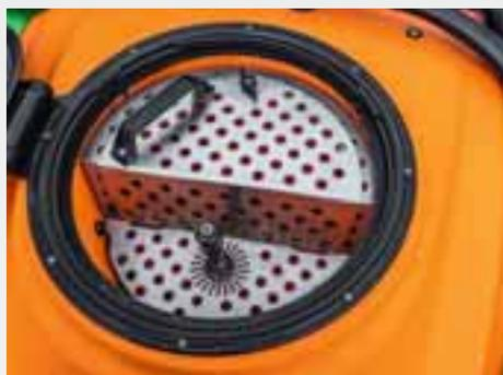
El gran dispositivo de incorporación situado debajo de la gran cubierta de cúpula fácil de abrir garantiza una dosificación segura y exacta de productos fitosanitarios y de otros aditivos.
