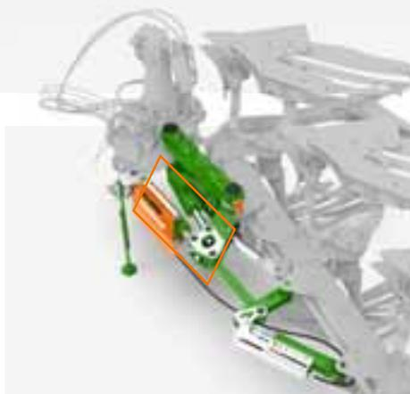
Por medio de AutoAdapt, al cambiar el ancho de trabajo total se ajusta automáticamente el surco delantero. El paralelograma y la unión hidráulica entre los cilindros del ancho de trabajo y del surco delantero posibilita una conexión exacta en todo tipo de conexiones.
