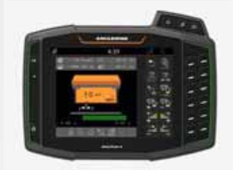
AMAZONE ofrece para el control ISOBUS del IceTiger el terminal de desarrollo propio AmaTron 4. La pantalla multitáctil a color de 8 pulgadas y baja reflexión permite un manejo cómodo como con una tablet.
