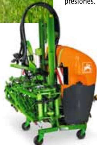
Pulverizador suspendido UF 901
