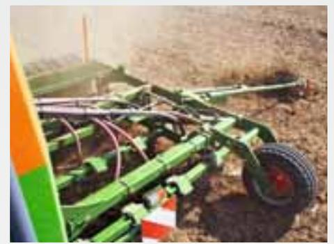
El depósito de semillas de la Cayena tiene una capacidad de 3600 l o de 4000 l y, a pesar de todo, su diseño es muy compacto. Esto asegura una excelente visión sobre las rejas TineTeC. La abertura del depósito abarca toda su superficie, lo que garantiza un llenado rápido y sencillo.
