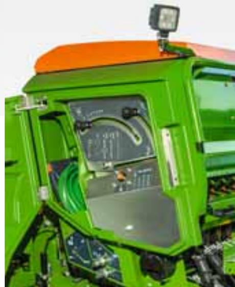
Para facilitar aún más el manejo, con el SmartCenter, AMAZONE ofrece una disposición muy fácil y clara de los ajustes más importantes. El sistema de dosificación eléctrico puede ajustarse y calibrarse rápidamente y de forma centralizada desde el lado izquierdo.
