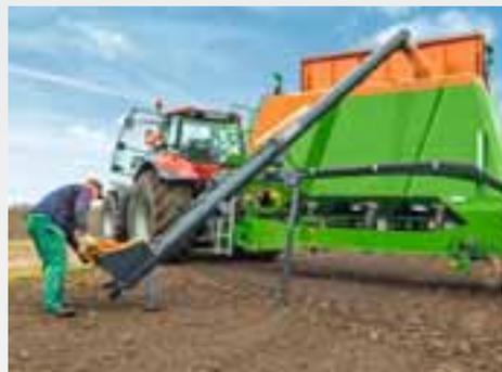
El tornillo sin fin de llenado TAM para la sembradora para grandes superficies Citan y la sembradora de reja Condor puede manejarse sin problemas con el controlador de la máquina. Las medidas de transporte continúan siendo inferiores a 4 m de altura y a 3 m de ancho.
