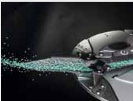
Para garantizar que el abono es tratado lo más cuidadosamente posible, el sistema de AMAZONE Soft Ballistic System pro se monta de serie en las abonadoras ZA-TS y ZG-TS. El agitador, los elementos de dosificación y los discos esparcidores están perfectamente adaptados entre sí.
