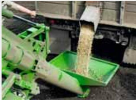
Para llenar el depósito del Primera DMC con semillas y abono, AMAZONE ofrece un tornillo sin fin de llenado con accionamiento hidráulico. Este permite reducir los tiempos de llenado a hasta 15 min. y aumentar correspondientemente la productividad de la máquina.
