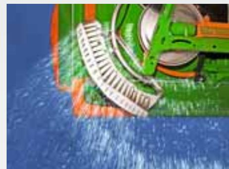
Gracias al dispositivo de dispersión en límite hidráulico a distancia Limiter no es necesario detener el tractor ni descender de él para distribuir el abono en cabeceras, límite de campo o zanjas.
