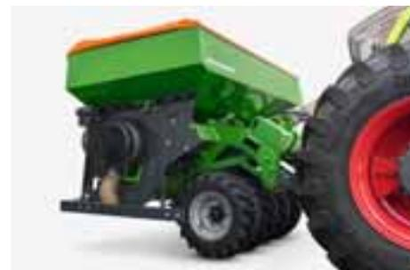
AMAZONE ofrece el FTender también con compactador de neumáticos frontal T-Pack F. El FTender, como depósito de semillas con compactador de neumáticos frontal con eje autodireccionable, muestra sus puntos fuertes especialmente durante la siembra y garantiza una buena recompactación entre las huellas del tractor.
