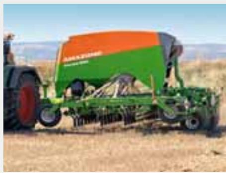
Gracias al enganche del brazo inferior, el tren de rodaje integrado y los portaútiles de plegado hidráulico, la nueva Cayena se muestra como una unidad compacta y muy manejable.
