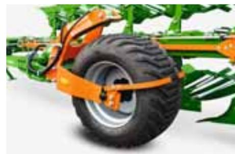
Hay disponibles varias ruedas del sistema semisuspendido de gran volumen para un accionamiento óptimo sobre el suelo y un guiado exacto de la profundidad de trabajo incluso en condiciones difíciles. El ajuste de la profundidad a través de la rueda del sistema semisuspendido tiene lugar cómodamente a través de un cilindro neumático o, sin herramientas, con clips en el vástago del émbolo.
