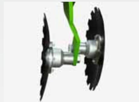
La unidad de grada de discos en dos hileras muelle, desmenuza y nivela el lecho de siembra antes de que se depositen las semillas. Con un ángulo de 14° en la fila de discos delantera y de 12° en la fila de discos trasera, los discos CombiDisc presentan una posición inclinada. Este ángulo asegura una nivelación óptima del lecho de siembra.
