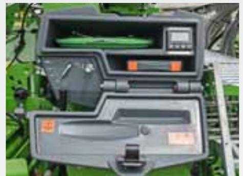
Por medio del SmartCenter, dispuesto en el lado izquierdo de la máquina, la Centaya Super se puede calibrar y ajustar cómodamente mientras permanece junto a la máquina. En una caja de transporte colocada directamente en la máquina se encuentran la báscula digital y un cubo plegable.
