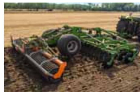
Para realizar un guiado de profundidad homogéneo de la máquina, la Certos-2TX se guía en la zona trasera sobre los rodillos arrastrados y en la zona delantera sobre las ruedas de apoyo.
