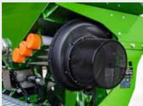
El accionamiento hidráulico de la turbina procura una cómoda adaptación de la velocidad de la turbina. El número de revoluciones de la turbina se ajusta de forma cómoda e independiente del régimen del motor, de modo que el número de revoluciones sea siempre constante y óptimo.
