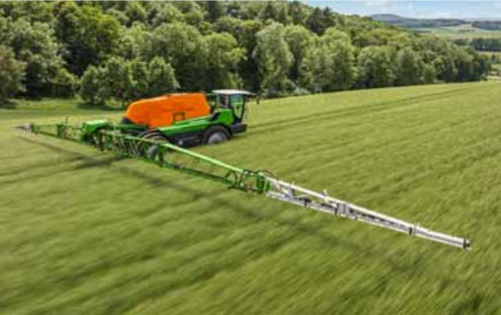
Pantera 7004 con barra Super L3 de 36 m de ancho
