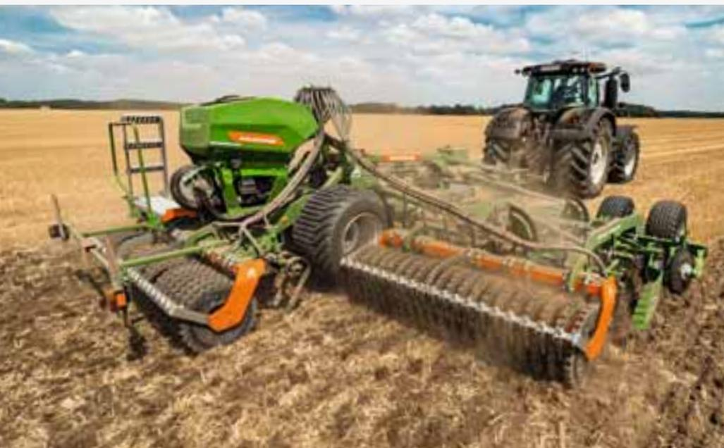
Grada de discos compacta Catros<sup>XL</sup> 8003-2TX con sembradora suspendida universal GreenDrill 501
