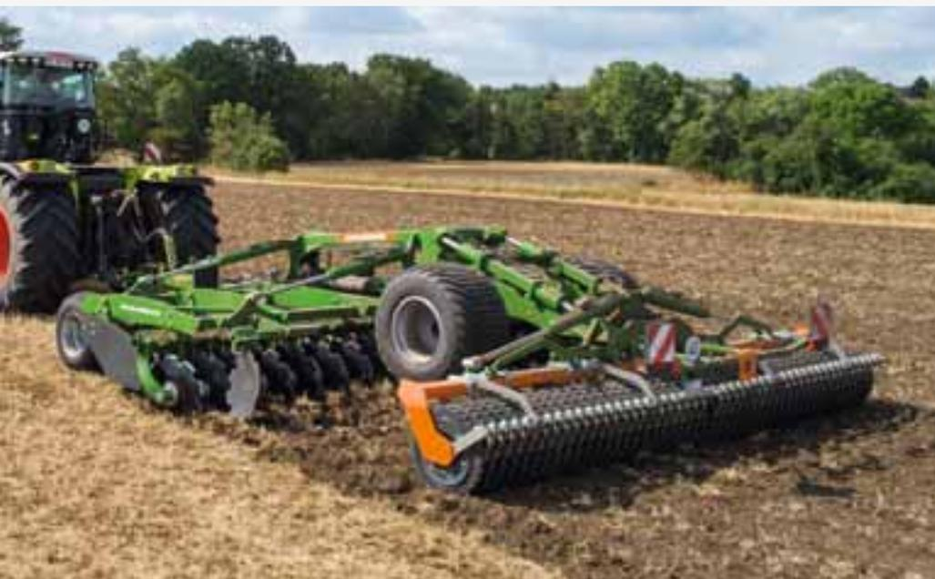
Certos 6002-2TX en un ancho de trabajo de 6 m con tren de rodaje medio TX
