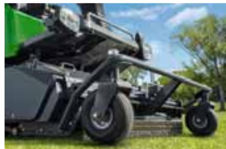
A través de la herramienta de mando posicionada en el mecanismo de corte de la Profihopper 1500 SmartLine es posible ajustar la altura de corte de forma variable entre 0 y 90 mm. Para ello se bascula el mecanismo de corte completo de modo que ninguna pieza situada a mayor profundidad merme el resultado del trabajo.
