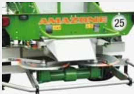
La ZG-B cuenta con un mecanismo de dispersión universal para esparcir materias ligeramente húmedas (cal) y fertilizantes minerales hasta un ancho de dispersión de 15 m y 36 m, respectivamente.
