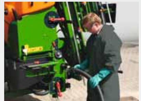
La central de mando del UF 01 se encuentra en la parte central izquierda de la máquina. Son suficientes tres válvulas de mando para manejar todas las funciones.
