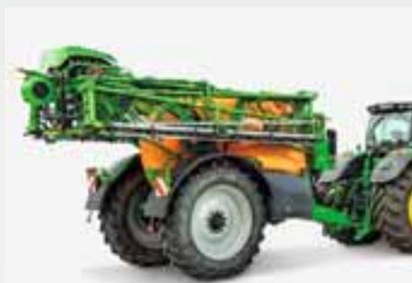
La barra Super-L2, de 21 a 36 m, se pliega junto al depósito de manera muy reducida con un ancho de transporte de sólo 2,6 m. Con una altura de transporte máxima de 3,8 m, el UX es muy compacto incluso si se usan neumáticos altos (18.4R46).
