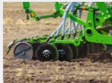
El sistema de reja de doble disco TwinTeC+ dispone de un ajuste hidráulico continuo de la presión de la reja que se extiende a lo largo de un rango de ajuste desde 15 hasta 100 kg. Esto permite adaptar la presión de forma rápida y sencilla a los cambios en las condiciones del terreno.
