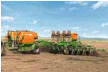
En combinación con la sembradora Primera DMC, la sembradora Condor o la sembradora monograno EDX, se puede utilizar un Fertiliser Delivery Cart FDC, especialmente en emplazamientos con cultivo de secano. Una bomba transporta el abono líquido a las rejillas de siembra, que lo aplican al suelo. Esta combinación se utiliza para realizar la siembra y el abonado inicial en una sola pasada.
