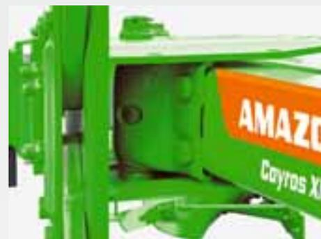
En el Cayros V, el ajuste del ancho de trabajo se lleva a cabo desde el tractor, de manera progresiva y por medios hidráulicos. El sistema es tan ingenioso que también corrige automáticamente el ajuste del punto de tracción y del ancho de trabajo, como no podía ser de otra manera.
