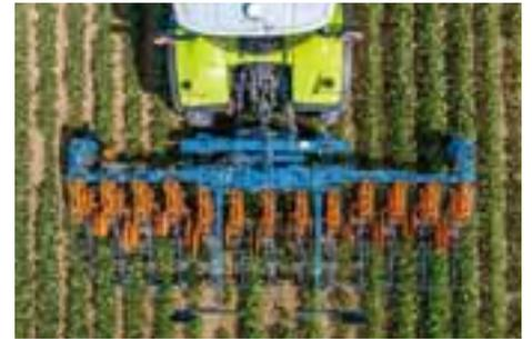
La profundidad de montaje tan baja del bastidor de desplazamiento permite situar el centro de gravedad de la binadora muy cerca del tractor.
