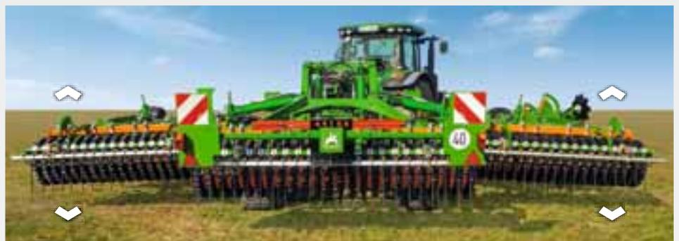
Al ContourFrame permite alcanzar adicionalmente una adaptación perfecta al terreno. En este caso, los cilindros hidráulicos de los segmentos exteriores se presurizan previamente mediante los acumuladores hidráulicos y se desplazan hasta la posición flotante, de tal forma que en cada uno de los tres segmentos sea posible una adaptación al terreno hacia arriba y hacia abajo. De esta forma, la máquina se adapta también de forma óptima al contorno de terrenos accidentados.
