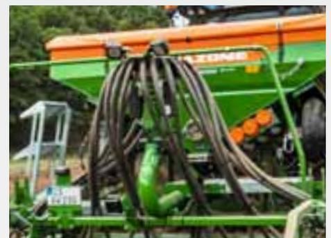
El cabezal distribuidor de segmentos de la Centaya Special está situado detrás del depósito de semillas y justo encima de las rejas. Esta disposición garantiza un trayecto corto de desplazamiento para las semillas.
