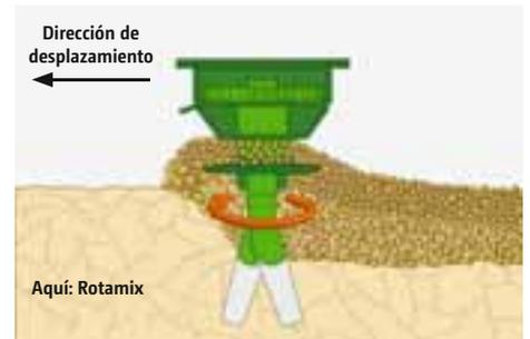
El sistema Rotamix presenta 4 portaherramientas por metro de ancho de trabajo con púas de arrastre. De este modo se logra una excelente estructura de desmenuzamiento y nivelado.
