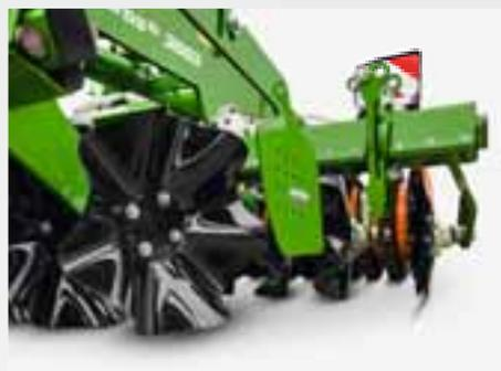
El X Cutter Disc con perfil ondulado se utiliza durante el laboreo del suelo a muy poca profundidad. El nuevo disco especial tiene un diámetro de 480 mm. De esta forma, alcanza una alta velocidad periférica y trabaja de forma óptima a profundidades de trabajo de 2 a 8 cm.
