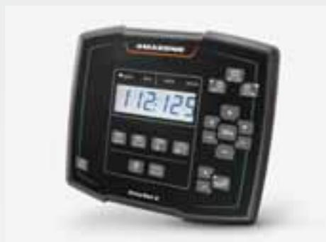
El ordenado de mando EasySet 2 permite regular automáticamente las cantidades al cambiar la velocidad de desplazamiento. Para ello, los orificios de salida se adaptan ajustando automáticamente las posiciones de las correderas de modo que la dosis de aplicación siempre es la misma.
