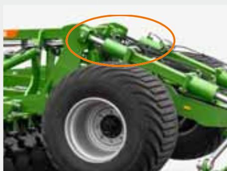
La inclinación del Certos se puede ajustar equipándolo con una correa superior hidráulica. Si se produce una tracción oblicua de la máquina, se puede compensar cómodamente desde el asiento del conductor en la cabina del tractor.
