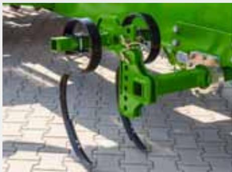
Para el uso sobre suelos descompactados o no recompactados se ofrecen borrahuellas opcionales. Las rodadas se deshacen y nivelan. La inserción y extracción, p. ej., en el extremo del campo o para plegar durante el transporte, tienen lugar de forma automática mediante un control hidráulico.
