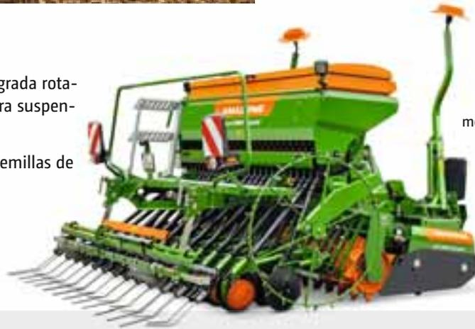
Cataya Special con accionamiento mecánico, rejas RoTeC y rastra de precisión
