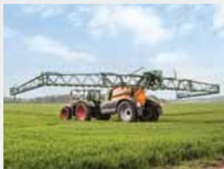
Con el plegado Profi o Flex, todas las funciones hidráulicas, también el plegado unilateral, pueden ejecutarse fácilmente y con fiabilidad a través del terminal ISOBUS desde la cabina del tractor.
