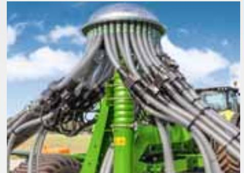
Un sistema de asistencia muy útil es el control opcional del conducto de semillas que detecta de inmediato bloqueos en la reja y en el conducto. Directamente detrás del cabezal distribuidor, los sensores de las mangueras de semillas controlan el flujo de semillas.
