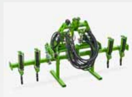
Junto con el borrahuellas para el cultivo intermedio, es posible descompactar la huella del tractor siempre que sea necesario. El borrahuellas no trabaja aquí en modo de mezcla, sino de descompactación. El borrahuellas también puede emplearse en combinación con otros equipos.
