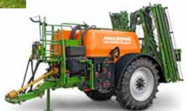
Pulverizador arrastrado UG 3000 Super con barra Super S2 de 15 m a 28 m
