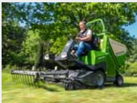
Con el nuevo InsectGuard, un portapúas se encarga de que se mueva la hierba delante del mecanismo de corte, lo que hace que los insectos salgan volando y que no los atropelle la Profihopper. ¡Proteger la naturaleza con InsectGuard!
