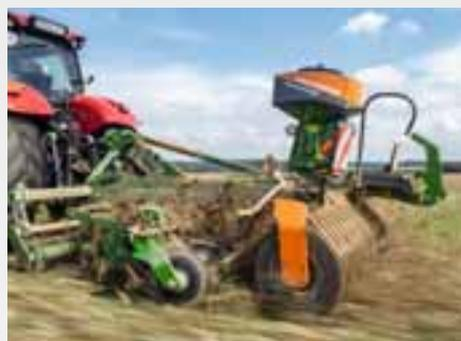
En la zona de dosificación debajo del depósito de semillas se encuentra un eje de sembrado equipado con ruedas de sembrado normales o finas, dependiendo de las propiedades de las semillas y de las dosis de siembra. La turbina puede ser activada eléctrica o hidráulicamente.
