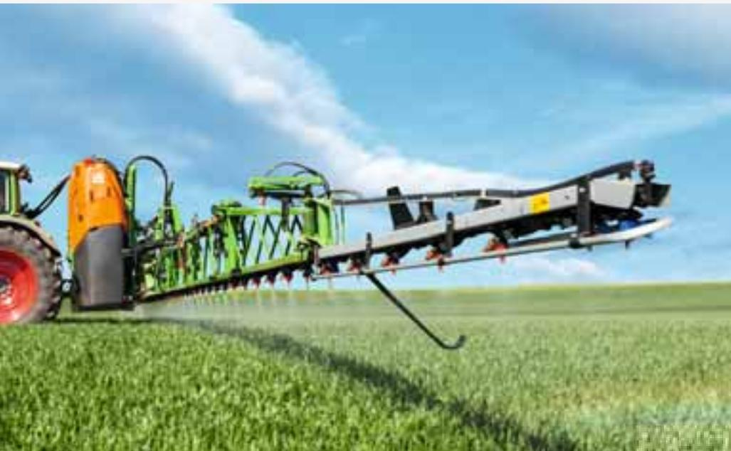
Pulverizador suspendido UF 2002 con barra Super S2 de 30 m
