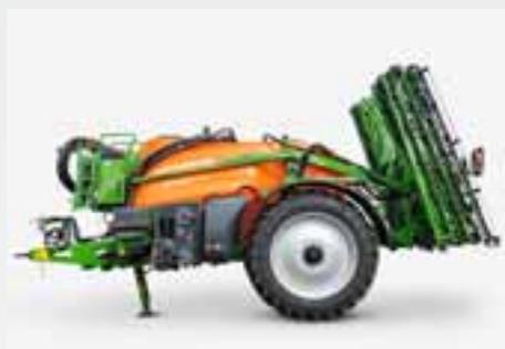
De forma alternativa, en el UX Special puede utilizarse también la barra Super S2 de 15 m a 28 m. Gracias al DistanceControl, todas las rampas pueden colocarse automáticamente en paralelo a la superficie de destino.
