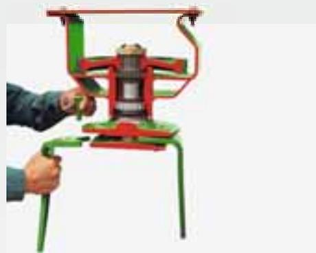
Sistema de cambio rápido de púas para gradas rotativas y cultivadores rotativos: Las púas se introducen en la cavidad del portapúas y se aseguran con un perno de chaveta. Más rápido y sencillo es imposible.
