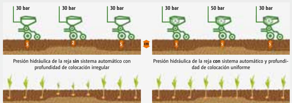
La presión de la reja puede ajustarse de forma fácil y cómoda mediante el ajuste hidráulico de la presión de la reja. Así, la presión de la reja puede ajustarse a una presión de hasta 350 kg mediante el terminal de mando, incluso durante la marcha.
