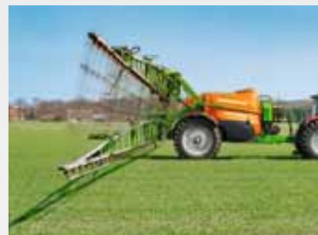
Por medio de la suspensión de paralelogramo del UX se logran alturas de pulverización de 0,5 m a 2,5 m. La posición de la barra es excelente en todas las direcciones de movimiento gracias a la coordinación óptima de los amortiguadores.
