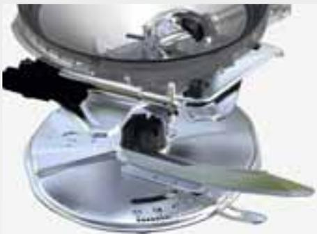
El moderno mecanismo de dispersión del ZA-V, con su gran apertura de la esclusa logra un caudal de hasta 390 kg/min. Las punta de la tolva que sobresale en la apertura de la esclusa evita que queden restos y es fácil de limpiar.
