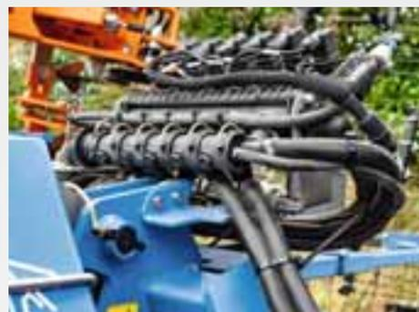
En cada uno de los equipos acoplados se puede montar de forma fija una unidad de control de ancho parcial con 2 a 6 anchos parciales. Diferentes máquinas pueden equiparse con una unidad de control de ancho parcial fija gracias a los puntos de separación situados delante de la unidad de control de ancho parcial.
