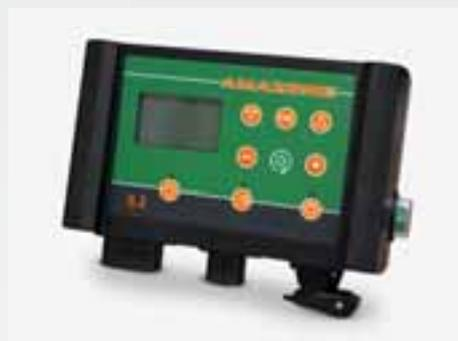
El ordenador de mando de la GreenDrill 200 permite conmutar entre el eje de sembrado y la turbina y ajustar el número de revoluciones del eje de sembrado. En la versión con el equipamiento de confort, el ordenador de mando ofrece además asistencia para la prueba de calibración y visualización de la superficie labrada.
