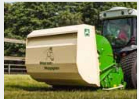
La escarificación y el segado del pasto de los caballos con recogida simultánea del material segado y la bosta de caballo evita que se formen puntos de fermentación y se multipliquen los parásitos.
