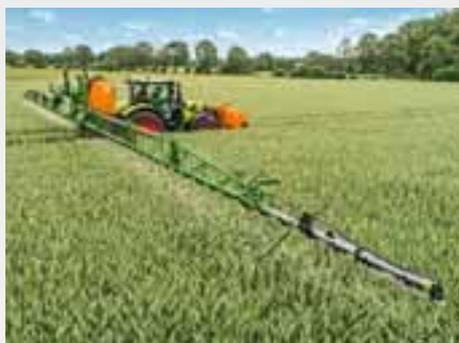
El sistema de gestión de nivel de llenado FlowControl+ integrado en el terminal ISOBUS garantiza una homogeneización óptima del líquido de pulverización en ambos depósitos según el nivel de llenado.
