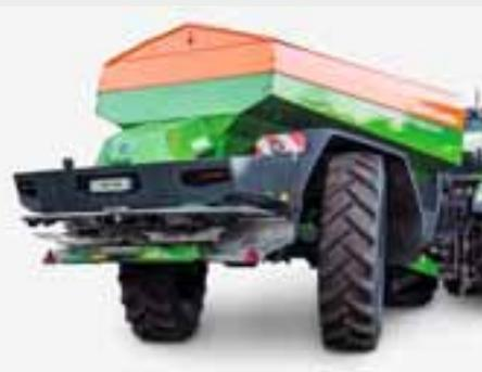
Provistas del eje de dirección opcional, las abonadoras arrastradas ZG-TS ofrecen un ángulo de dirección máximo de hasta 28°. Esto significa: Un ancho de vía de 1.800 mm y un ancho de neumático de 520 mm bastan para hacer posible un seguimiento fiel de la traza.
