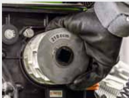
El sistema de dosificación es apto para todo tipo de semillas y cantidades de hasta 400 kg/ha a una velocidad de desplazamiento de 15 km/h. El cambio de semillas finas a normales se lleva a cabo en segundos mediante los rodillos dosificadores.
