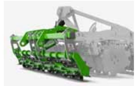
El rodillo de cuchillas permite el laboreo del suelo a muy poca profundidad con un cultivo simultánea de los rastrojos, p. ej., durante la primera operación de rastrojos en la colza.
