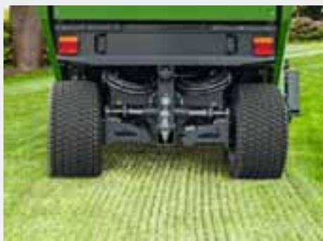
La Profihopper también le permite escarificar de forma extraordinaria. Las cuchillas escarificadoras, que pueden montarse con rapidez y sin herramientas, seccionan el césped y aclaran la superficie de la hierba. El césped cortado se peina y se recoge, a la vez que se allana el terreno.
