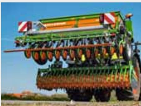
Gracias al sistema de transporte combinado, la sembradora se levanta hacia adelante para reducir la fuerza de elevación necesaria durante el transporte o en cabeceras.
