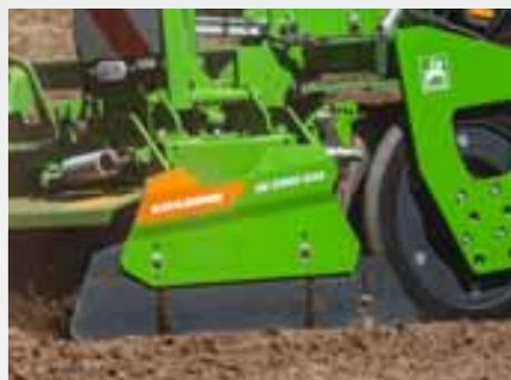
Las chapas deflectoras laterales de nuevo desarrollo cuentan con resortes. Gracias a su suspensión, las chapas deflectoras laterales pueden ajustarse a lo largo de un orificio oblongo y sustituirse fácilmente cuando se desgastan. Para el ajuste basta con usar la herramienta de control universal incluida en el suministro.
