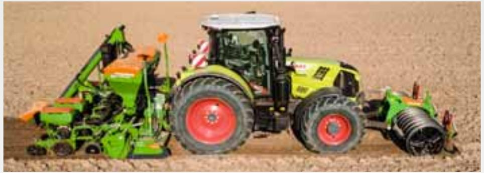
Gracias al sistema inteligente de acoplamiento rápido QuickLink para las sembradoras suspendidas de 3 m y de 4 m, la sembradora combinada se puede separar de manera muy fácil en unos pocos minutos. Los tres puntos de acoplamiento del sistema de enganche rápido QuickLink ofrecen un buen acceso y permiten acoplar y desacoplar con seguridad y rapidez y sin necesidad de usar herramientas. Así, el dispositivo de labrado también resulta perfecto para el uso individual.
