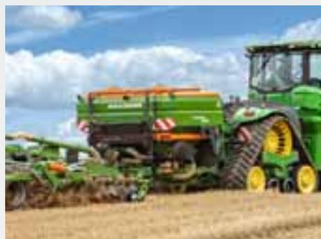
El XTender ofrece un montaje favorable al centro de gravedad sobre 3 puntos (cat. 3/4N) en el tractor. El acoplamiento de la máquina trasera al XTender se realiza igualmente mediante un enganche del brazo inferior normalizado en las categorías 3 o 4N.
