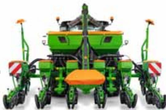
Precea 4500-2CC con bastidor telescópico variable en todo el ancho de trabajo
