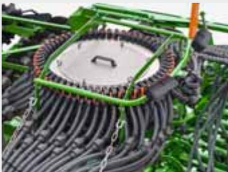
El nuevo cabezal distribuidor se encarga aquí de una buena distribución transversal. Dotado de una desconexión de filas individuales, asegura una elevada sostenibilidad mediante el ahorro de semillas y abono.
