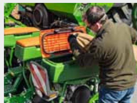
Los depósitos de semillas tienen una capacidad de 55 o 70 l. Los depósitos presurizados pueden abrirse con una mano y están protegidos mediante un labio de goma para evitar que entre polvo. Además, hay un verdedor en una tapa del depósito para retirar las semillas remanentes.
