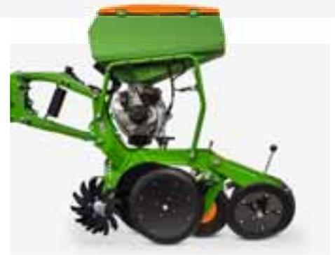
La reja de siembra directa antierosiva PreTeC dispone de una presión de reja máx. de 220 kg en el caso de la presión de reja por medios mecánicos o de 400 kg en el caso de presión de reja por medios hidráulicos. De este modo se garantiza una marcha suave y una germinación uniforme incluso en las condiciones más duras del terreno.
