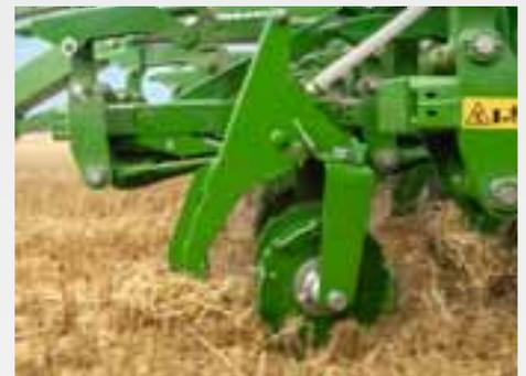
Los abresurcos de reja se encuentran completamente suspendidos en paralelogramos. Esto evita los problemas de mantenimiento de la profundidad de siembra deseada en caso de velocidades de desplazamiento diferentes o cambiantes e irregularidades adicionales en el terreno.
