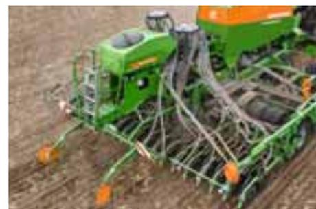
La sembradora suspendida neumática universal GreenDrill para la sembradora combinada arrastrada Cirrus permite al usuario aplicar otro medio sobre la superficie del terreno durante la siembra, ya sean semillas de hierba o producto anticaracoles.
