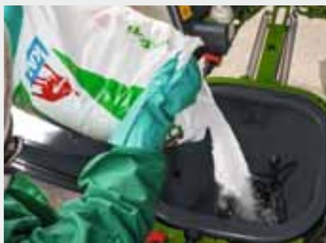
Con el fin de introducir eficazmente los materiales en forma de polvo y granulado, una boquilla de mezcla adicional se encuentra debajo de la abertura de aspiración, lo que evita de manera fiable la obstrucción de la abertura de aspiración. El rendimiento de esta boquilla de mezcla se puede ajustar de forma continua.
