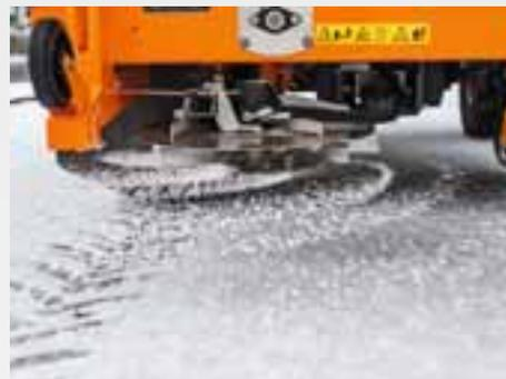
Además, el sistema Smart Precision con la regulación eléctrica del punto de alimentación a través de ISOBUS ofrece una ventaja fundamental. Aquí, el ancho de esparcido deseado en el lado izquierdo y derecho se ajusta cómodamente desde el asiento del tractor.
