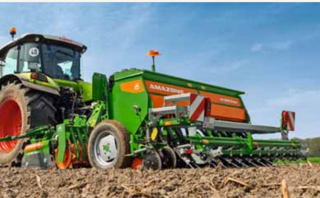
D9 3000 Super con rastra de precisión combinada con grada rotativa y rodillo dentado
