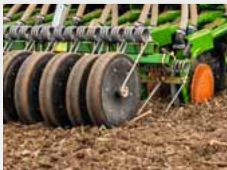
La rastra de rodillos comprime el suelo sobre el surco de siembra para proporcionar unas condiciones de germinación óptimas. Se recomienda especialmente en suelos ligeros y secos cuando se siembran semillas para cosecha estival o semillas de colza.
