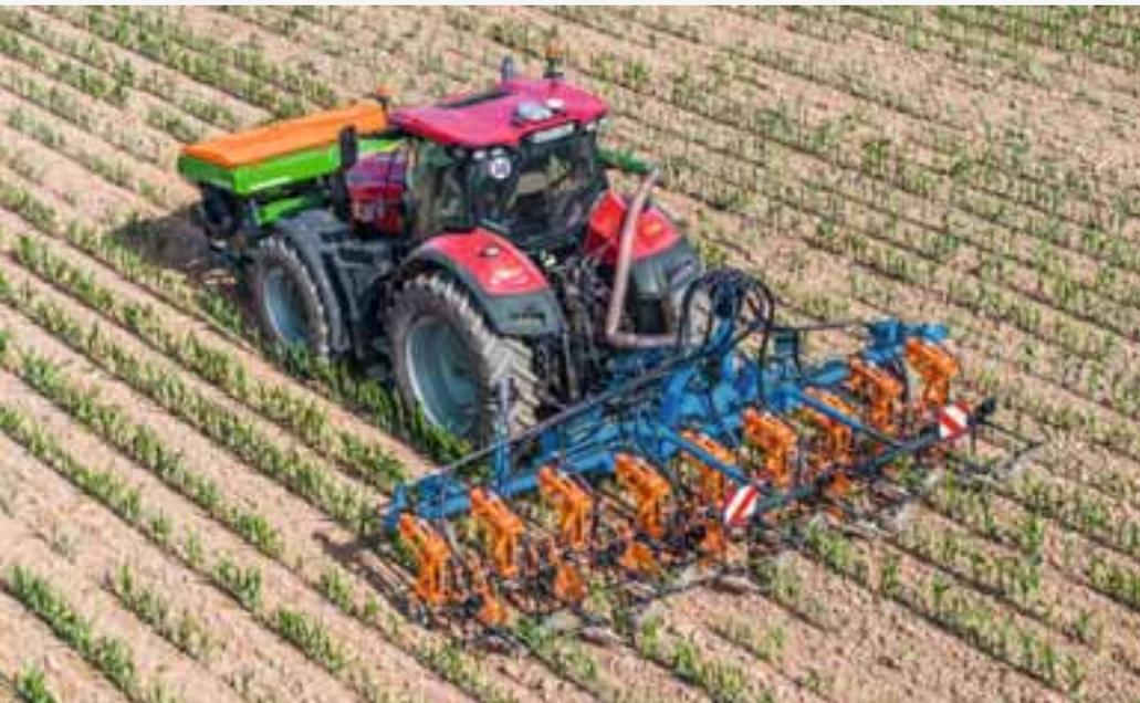
Venterra 2K en combinación con el depósito de montaje frontal FTender para la fertilización en hileras
