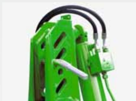
Todas las torres acopladas cuentan con orificios oblongos para la fijación del brazo superior. Si se posiciona el brazo superior en el orificio oblongo, el conjunto de arado y tractor puede adaptarse a la perfección a las irregularidades del terreno manteniendo así la profundidad de trabajo deseada.
