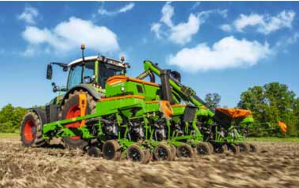
Sembradora monograno Precea 6000-2CC de 8 hileras en funcionamiento
