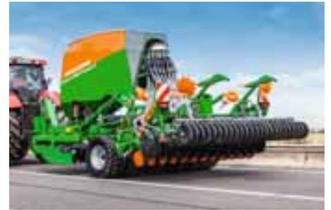
Con los neumáticos Matrix desarrollados para la Cirrus, la máquina completamente llena de semillas puede alcanzar de forma segura una velocidad de 40 km/h en carretera. Así se cumple además el código de circulación al 100%. El enganche en el brazo inferior permite una maniobrabilidad extraordinaria de la Cirrus, por ejemplo, en cabeceras.
