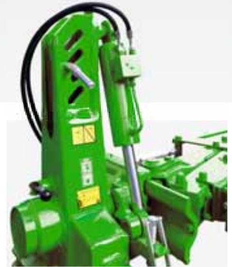
Todos los mecanismos de giro de los arados Cayros disponen de una función de viraje mediante cilindro de doble acción con conmutación automática. De este modo, el viraje del arado se realiza con suavidad y sin tirones. Además, el arado puede girarse con una válvula de control de efecto simple con retorno sin presión. El guiado inteligente de los tubos flexibles evita daños.
