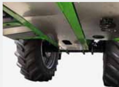
Gracias al revestimiento de los bajos, el UX Super ofrece una solución perfecta para la protección óptima de la máquina y los cultivos, incluso en plantaciones altas. Gracias al revestimiento de los bajos, la parte inferior completa de la unidad está revestida con chapas de acero inoxidable, de forma que el tren de rodaje y los cultivos están protegidos de forma óptima.
