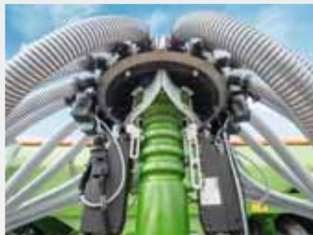
El cabezal distribuidor de segmentos está situado detrás del depósito de semillas y justo encima de las rejas. Gracias al cabezal distribuidor de segmentos, la Centaya Super también se puede desconectar de solo un lado, p. ej., si las calles del borde del campo son asimétricas.
