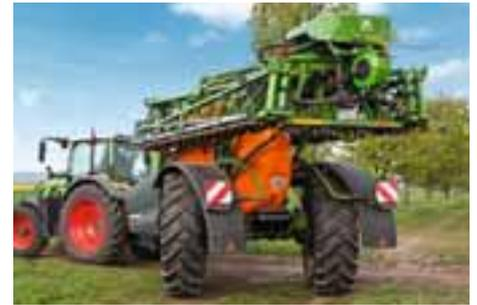
El UX Super dispone también de un nuevo eje de dirección con un ángulo de dirección máx. de 28°. Gracias a esta gran capacidad de giro de la dirección y a su forma compacta, el UX Super puede trazar curvas muy cerradas. Según los neumáticos y el ancho de vía, se puede alcanzar un radio de curva mínimo de 4,5 m.
