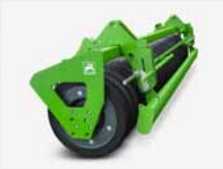
La barra de nivelación nivela el flujo de tierra entre las púas y el rodillo, presionando los obstáculos hacia abajo. Con la herramienta de control universal se puede ajustar cómodamente la altura de la barra de nivelación.
