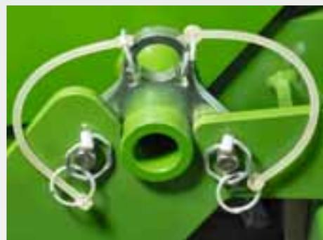
Los tres puntos de acoplamiento del sistema de enganche rápido QuickLink ofrecen un buen acceso y permiten acoplar y desacoplar con seguridad y rapidez y sin necesidad de usar herramientas.
