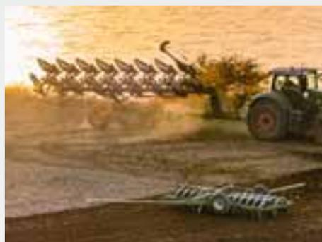
Por medio de una amortiguación de dos etapas en las posiciones finales se ralentiza el proceso de giro del arado justo antes del final. Esto tiene un efecto de amortiguación que protege el material al retraer el cilindro.
