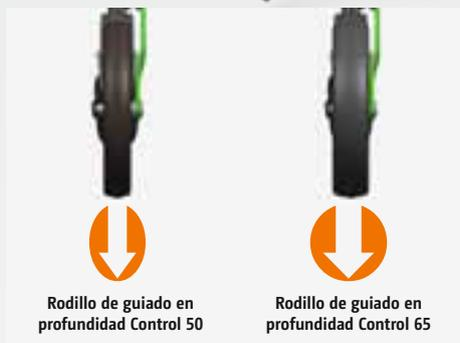
La reja TwinTeC proporciona una colocación de las semillas muy limpia. El rodillo de guiado en profundidad Control 50 mm tiene un paso alto y es idóneo para suelos pesados y firmes. El rodillo de guiado en profundidad Control 65 mm ofrece una mayor fuerza portante, especialmente en terrenos más ligeros.
