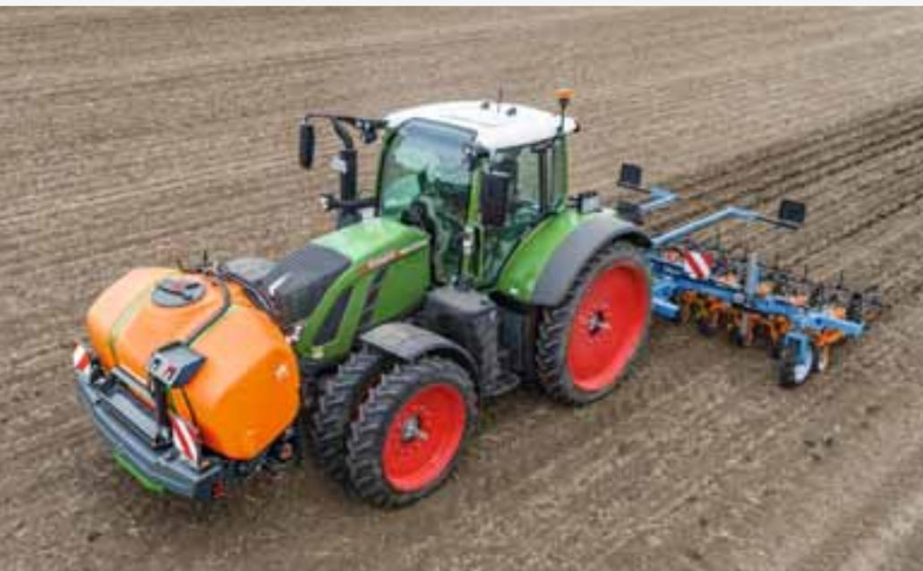
Depósito frontal FT-P 1502 en uso con una binadora SCHMOTZER para la pulverización en bandas
