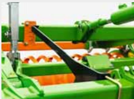
La configuración de la profundidad tiene lugar de forma mecánica (de serie) mediante un mando superior o de forma hidráulica cómodamente desde el asiento del tractor. De este modo, durante el transporte se puede reaccionar ante los distintos comportamientos del suelo.
