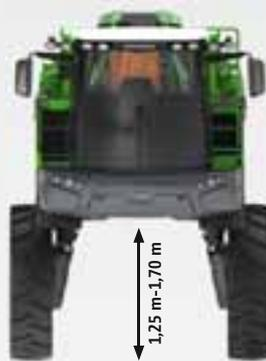
Ajuste del ancho de vía 1,80 m-2,40 m (abajo)
