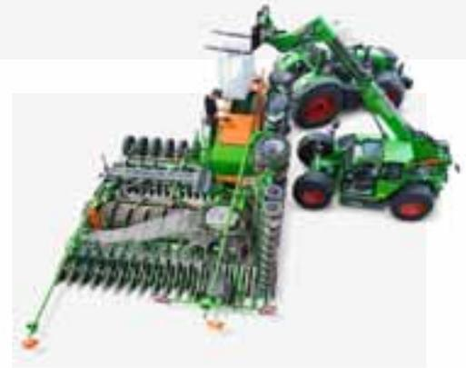
A fin de posibilitar una carga de la máquina también con cargadores telescópicos más pequeños, el ancho de trasvase puede reducirse notablemente durante la carga mediante el plegado de un lado.
