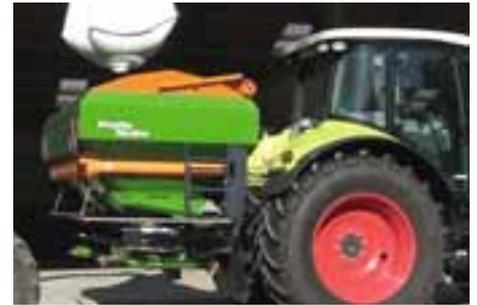
El toldo con manejo hidráulico del ZA-V y ZA-TS le permite también continuar la dispersión en condiciones meteorológicas adversas.
