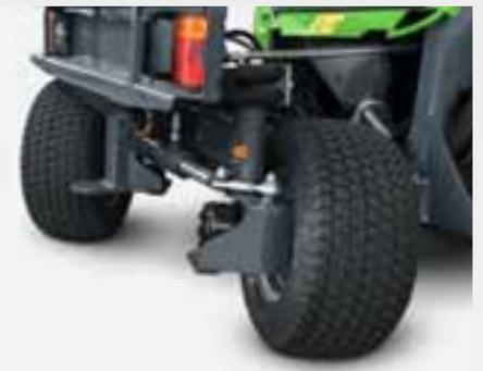
En la Profihopper 4WDi SmartLine, cada rueda se propulsa con las revoluciones necesarias según el accionamiento del acelerador y el ángulo de giro del volante. En las condiciones de uso más difíciles es cuando el usuario más se beneficia de la tracción total inteligente.
