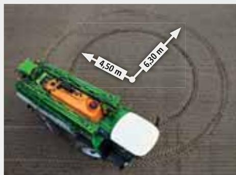
A pesar del tamaño del vehículo, el radio de viraje mínimo del Pantera 4504 es de solo 4,5 m cuando se conduce con todas las ruedas direccionales. La corta distancia entre ejes y el gran ángulo de giro lo hacen posible.
