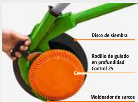
Las rejas RoTeC para siembra con arado y siembra directa antierosiva poseen un rodillo de guiado en profundidad Control 25, con el que se ajusta la profundidad de siembra de forma precisa y sin necesidad de herramientas.
