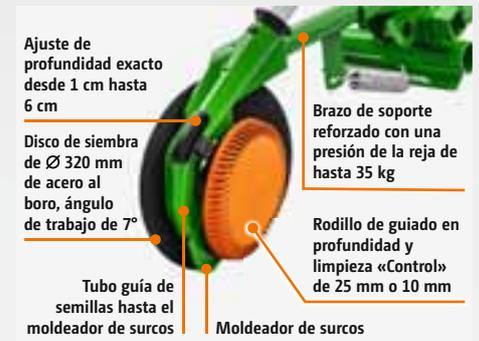
La Cataya Special está equipada con rejas RoTeC y una distancia de reja de 12,5 cm o 15 cm, a elección del cliente. La profundidad de siembra se puede ajustar directamente en las rejas y tiene 3 posiciones distintas.
