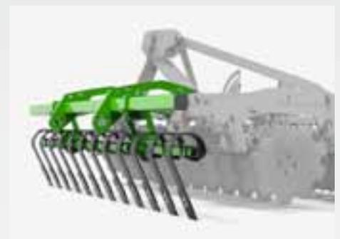
Para nivelar y desmenuzar mejor se dispone opcionalmente de un Crushboard delante o detrás de las filas de discos. Este permite romper terrones superficiales gruesos, especialmente tras el arado.
