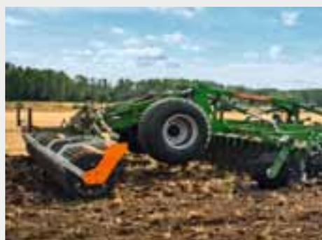
El tren de rodaje medio integrado confiere a la Certos 2TX una gran maniobrabilidad. Para conseguir un funcionamiento más suave y la misma calidad del trabajo, el Certos-2TX está equipado de serie con amortiguador en la lanza.
