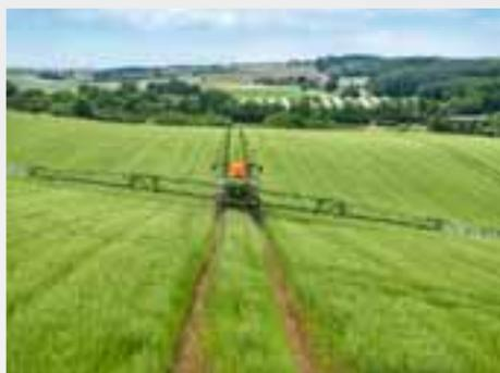
Otro aspecto destacado de esta máquina es la compensación de pendientes integrada. Unos sensores detectan la inclinación del vehículo, y la máquina se mantiene automáticamente en posición horizontal hasta una determinada inclinación de la pendiente.
