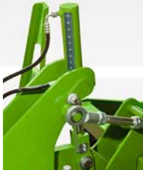
La regulación hidráulica opcional de la profundidad de los cultivadores rotativos KX y KG brinda al conductor un gran confort. De este modo es posible regular de forma progresiva y cómodamente desde la cabina la profundidad de trabajo de la grada rotativa, por ejemplo, para un trabajo más profundo en los extremos del campo o en las rodadas.
