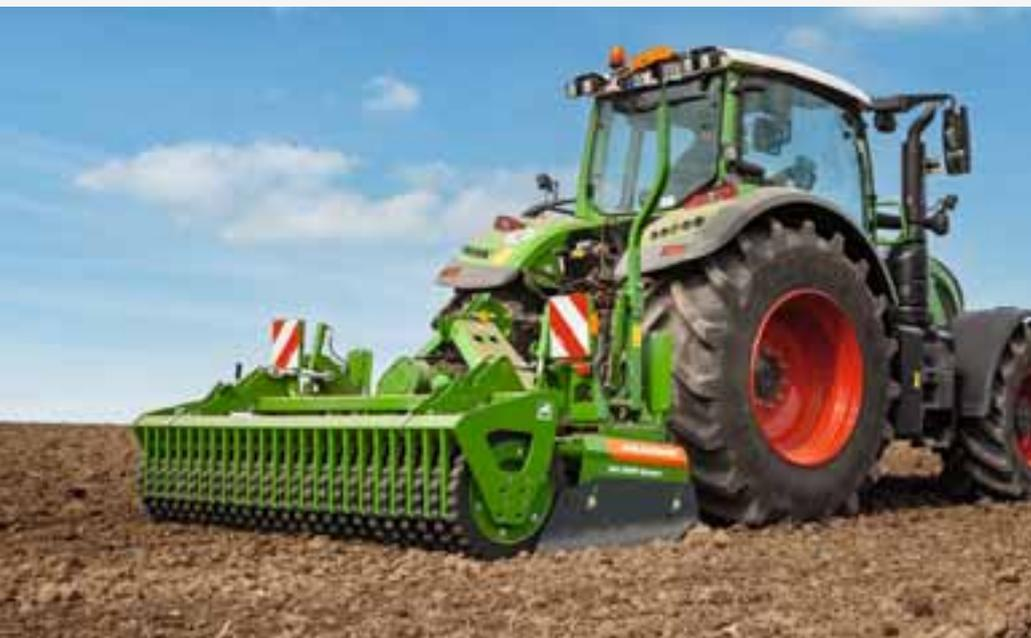
Grada rotativa KG 3001 con rodillo de anillo cónico con perfil de neumático Matrix
