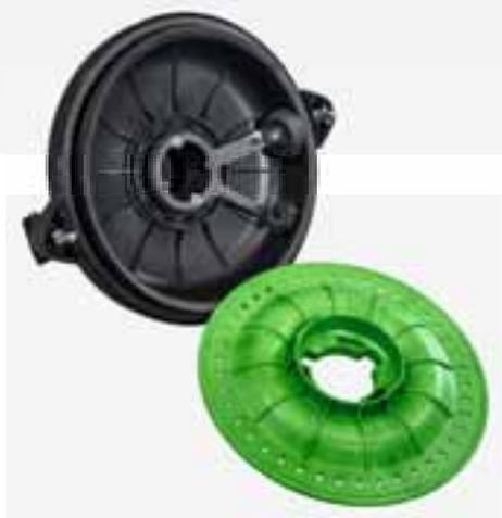
La separación precisa es el elemento central de la Precea. La dosificación se realiza por sobrepresión. Durante este proceso, la turbina aplica sobrepresión sobre las semillas y la dosificación completa. Tres raspadores se encargan de retirar el exceso de granos para evitar la aplicación doble. El resultado es una separación muy precisa, incluso a altas velocidades de hasta 15 km/h.
