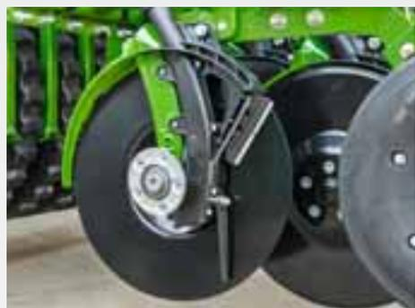
La sembradora suspendida Cataya Super está equipada opcionalmente con rejas de un solo disco RoTeC o con rejas de doble disco TwinTeC.
