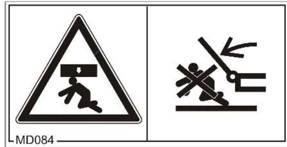
**MD 089****Danger !****Risque d'écrasement de l'ensemble du corps au niveau de l'espace dangereux sous des charges / éléments de la machine en suspens !**
