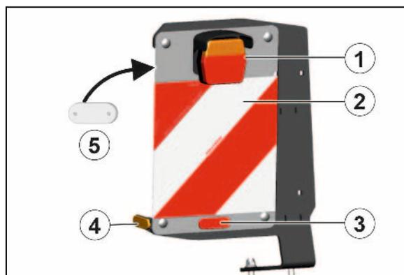
Raccordez la fiche du système d'éclairage à la prise à 7 pôles du tracteur.
