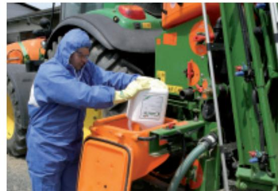
**Leistungsstarke Einspülschleuse:** Die Flüssigkeitsführung ist so gewählt, dass beim Ansaugen die Einspülschleuse immer von Klarwasser durchspült wird.
