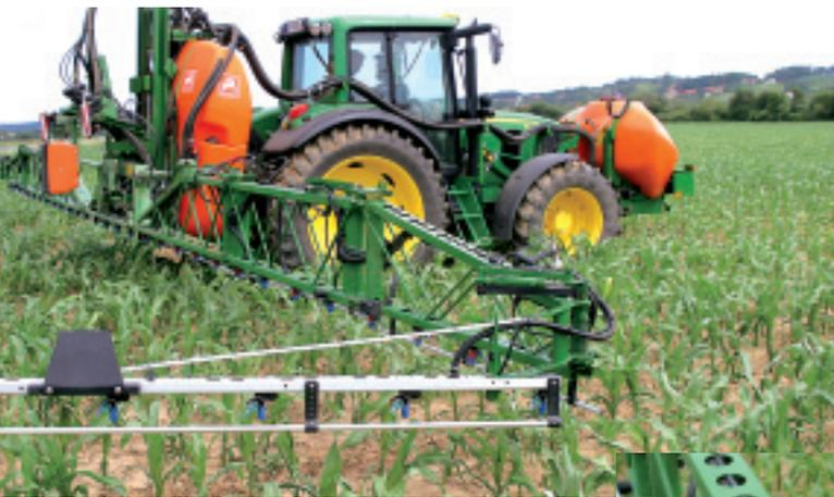
◀ **Dieser Spritzbalken hat zwei Arbeitsbreiten: 15 oder 21 m. Die Umstellung erfolgt jeweils mit zwei Absperrhähnen an den äußersten Teilbreiten.**
