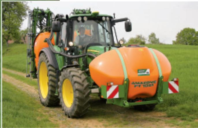
Der Fronttank ist nicht nur ein optischer Leckerbissen, sondern dient gleichzeitig auch als Frontgewicht und ermöglicht dank Flow-Control eine optimale Gewichtsverteilung.
