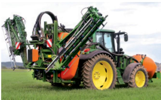
ge bzw. an den Düsen zu vermeiden. Ist dieser Gestängetyp nur auf 15 m ausgeklappt, gilt es auch zu beachten, dass die äußeren Segmente über keinen Anfahrerschutz verfügen.
