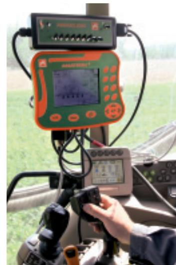
Bedienungs- und Überwachungsmöglichkeiten: Amaclick, Amatron+ und Multifunktionsgriff
