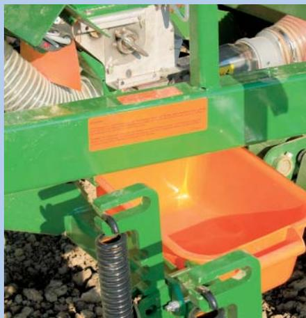
Удачное решение: лотки могут задвигаться под дозирующее устройство по специальным направляющим. Точность высева хорошая.
