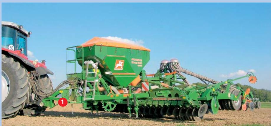
На поворотной полосе агрегат может опираться либо полностью на 6-метровый каток, либо на две пары транспортных колес шириной 80 см (см. фото). Центр вращения (1) смещен назад, поэтому маневренность хороша. Разрешенная транспортная скорость на дорогах составляет 40 км/ч.
