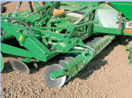
Диски диаметром 460 мм расположены под небольшим углом. Они хорошо выравняют почву, особенно при скорости более 10 км/ч. Регулировка глубины осуществляется гидравлически.
