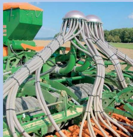
Обе распределяющие головки расположены сзади. Пневматика работала надежно, поперечное распределение хорошее.
