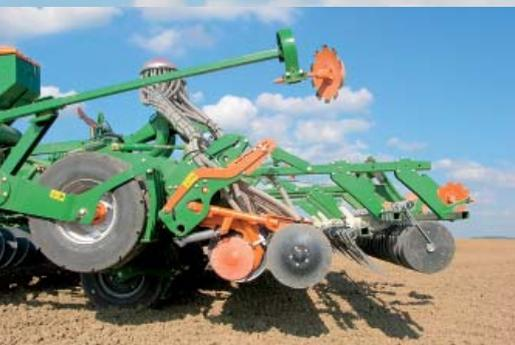
Сошники RoTec+: 400-миллиметровые диски из борной стали расположены друг за другом с интервалом 40 см. Максимально возможная сила давления на почву составляет 50 даН. Этого достаточно для работы в условиях средней сложности.
