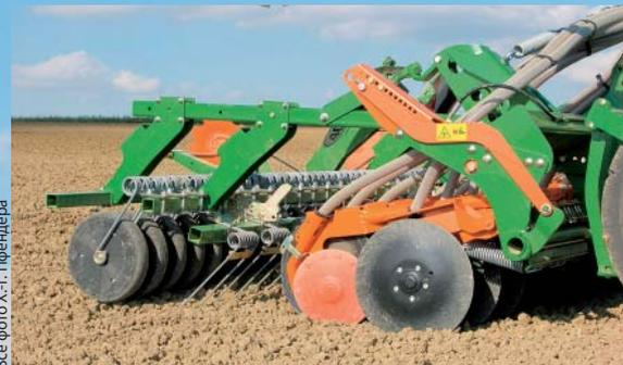
Пластиковые диски (280 мм) очищают сошники и помогают регулировать глубину обработки. Оранжевые «тарелки» могут занимать одну из трех позиций.
