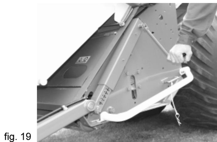
Girando esta manivela en el sentido horario, el rulo se levanta y la altura de corte disminuye. Girando en el sentido contrario, el rulo baja y la altura de corte aumenta (fig. 20).
