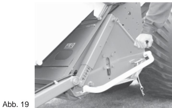
Durch Drehen im Uhrzeigersinn wird die Stützrolle eingefahren, die Schnitthöhe somit verkleinert; durch Drehen gegen den Uhrzeigersinn wird die Stützrolle ausgefahren und die Schnitthöhe vergrößert (Siehe Abb. 20).
