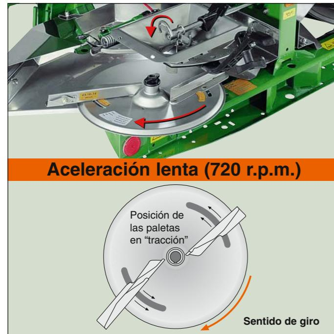
El **AMAZONE Soft Ballistic System** con baja velocidad de los discos de 720 r.p.m. protege el fertilizante durante la aceleración. Incluso los tipos de fertilizantes con menor resistencia a la ruptura mantienen sus propiedades de dispersión.
