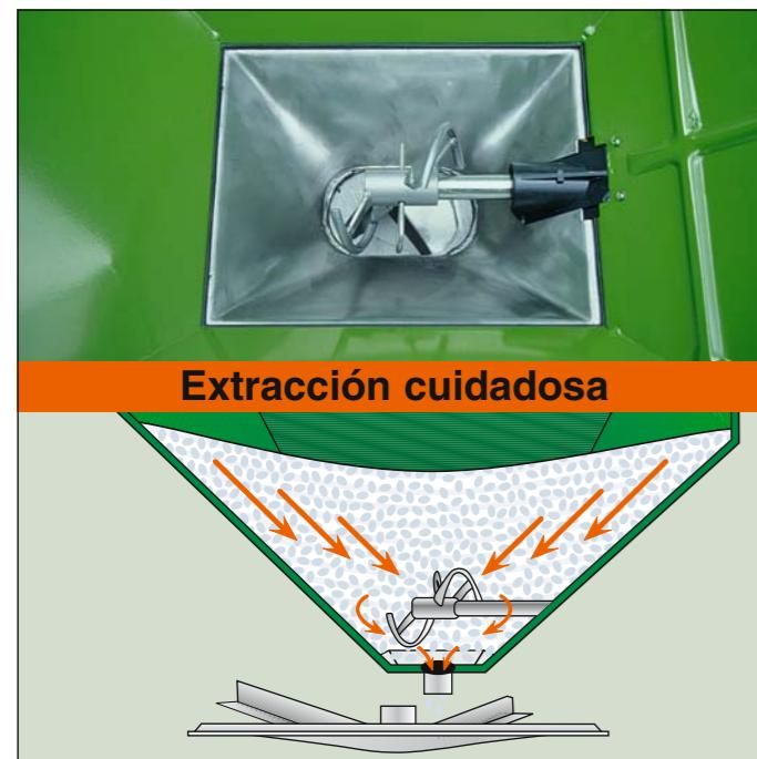
El **AMAZONE Soft Ballistic System** dispone de agitadores que están diseñados de tal forma, que el abono sale de la tolva en forma de chorro plano y ancho, impidiendo la formación de montículos de fertilizantes en medio de la tolva.
