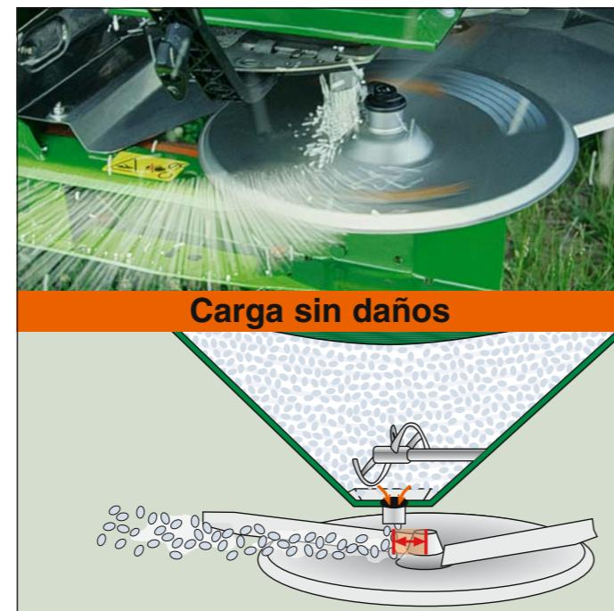
La colocación del fertilizante directamente en el centro del disco esparcidor es especialmente ventajosa porque la velocidad periférica de los discos en este sector es muy baja.
