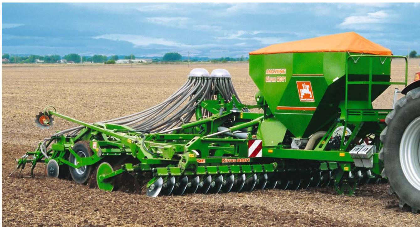
Le semoir à disques Cirrus avec disques de préparation
