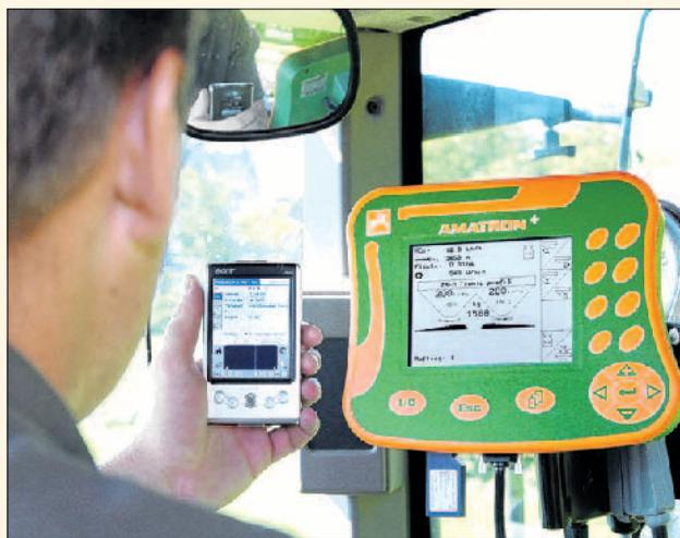
Der Amatron-Computer im Einsatz: Alle Amazone-Maschinen sind direkt vom Traktor aus bedienbar.
