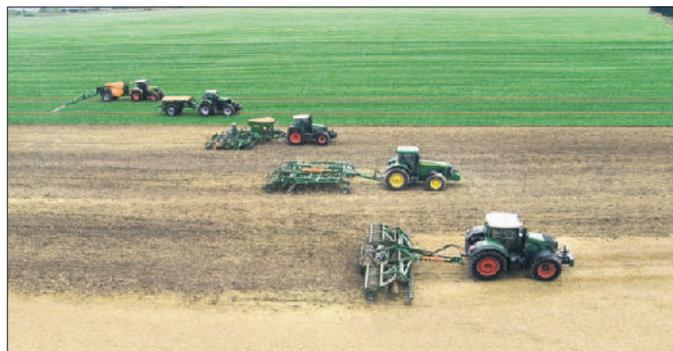
**Verfahrenstechnik mit System:** Das 3C-Ackerbau-Konzept kombiniert Eggen, Grubbern, Säen, Streuen und Spritzen optimal.
