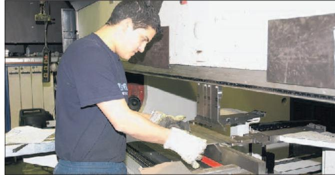
**Mit computergesteuerter CNC-Abkantpresse** bearbeitet Industriemechaniker Cos Kun Güngör Stahlbleche.
